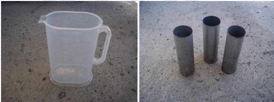
Şekil 3.7. Plastik ölçü kabı ve galvanizli silindirik huni
