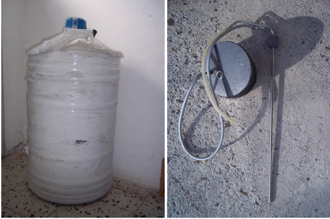
Şekil 3.6. Sıvı nitrojen tankı ve sıvı nitrojen aktarım körüğü
