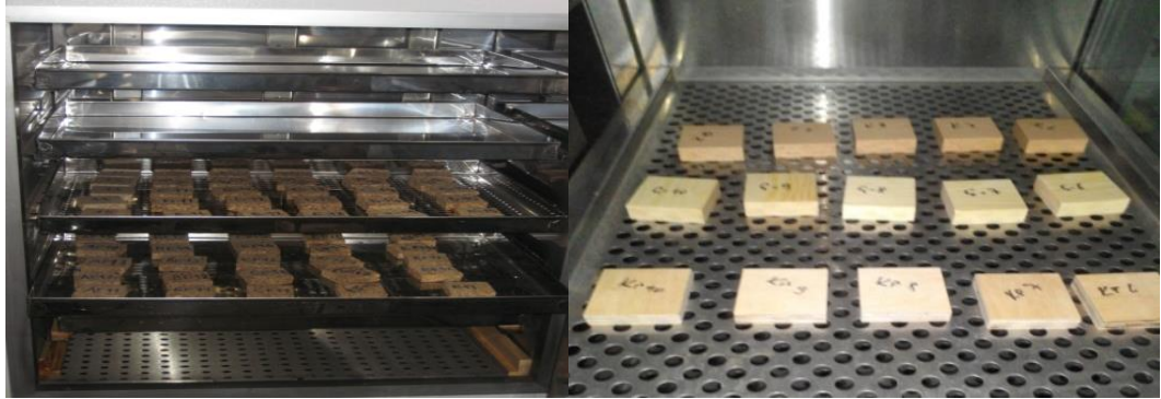
Şekil 3.4. Yoğunluk ve rutubet testleri için deney örneklerinin iklendirilmesi
