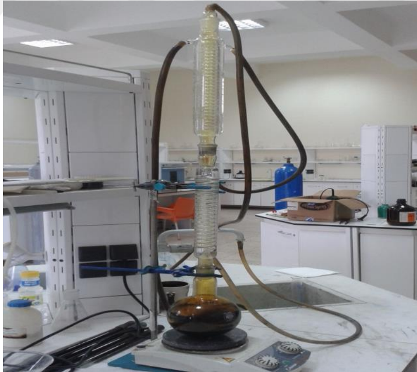
Şekil 3.1. Karbon nanotüpün sentezleme sistemi.
