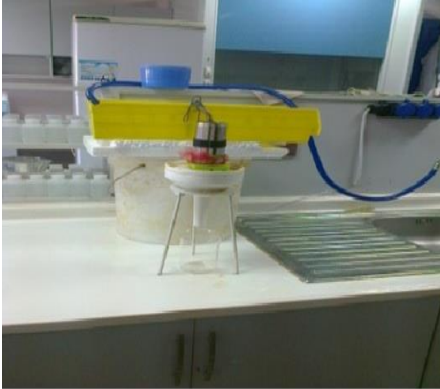
Şekil 3.10. Hidrolik iletkenlik sistemi
