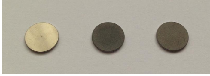
Şekil 5.10 Kimyasal muamele edilmiş disk şeklindeki Ti alaşımlı implant malzemeler (soldan sağa sırasıyla; talaşlı işlenmiş, \text{TiO}_2 ile kumlanmış, BCP ile kumlanmış)
