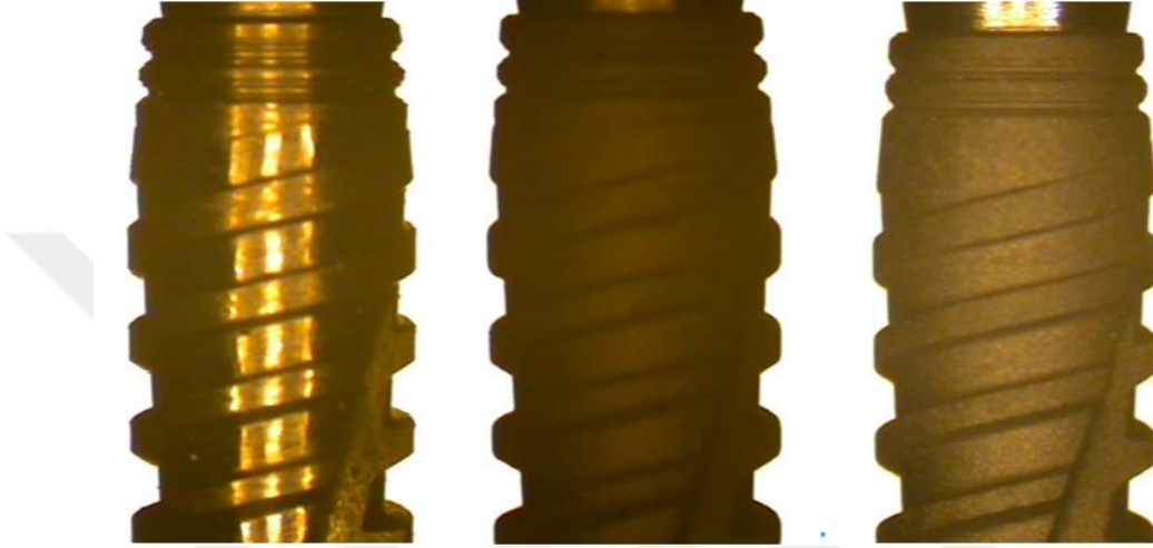
Şekil 5.11 Kimyasal muamele edilmiş implant şeklindeki Ti alaşımlı implant malzemelerin 3 boyutlu ölçüm cihazı 26X görüntüleri (soldan sağa sırasıyla; talaşlı işlenmiş, \text{TiO}_2 ile kumlanmış, BCP ile kumlanmış)
