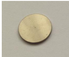
Şekil 5.3 Talaşlı işleme disk haline getirilmiş Ti numune
