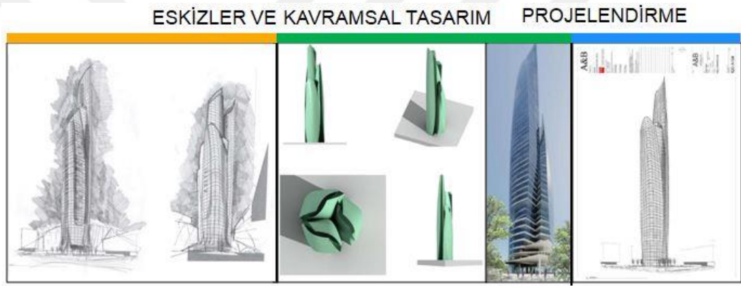
Şekil C.1. Revit'te Eskiz Kavramsal Modelleme ve Projelendirme (Autodesk DAM, 2010)
