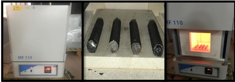
Şekil 7.6 Isıl İşlem İçin Kullanılan Fırın ve Numunelerin Fırın İçinde Dizilişi
