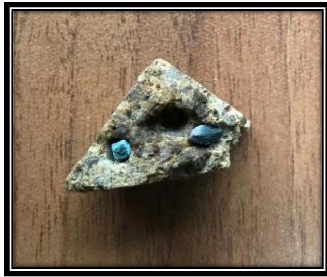
Şekil 7.17 MgO-C Refrakterin Kolemanitli ve Kolemanitsiz Cürufla Etkileşimi
