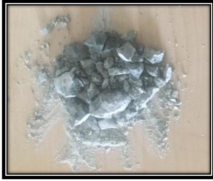
Şekil 7.2 20 kg Kolemanit Kullanılarak Elde Edilen ve Soğuduktan Sonra Tozlaşan Cüruf
