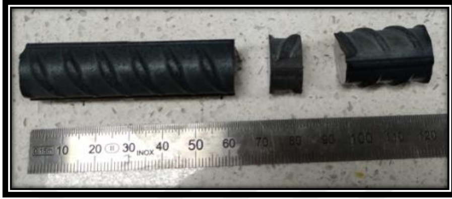
Şekil 7.7 Sertlik Testi İçin Alınan Numune Örneği
