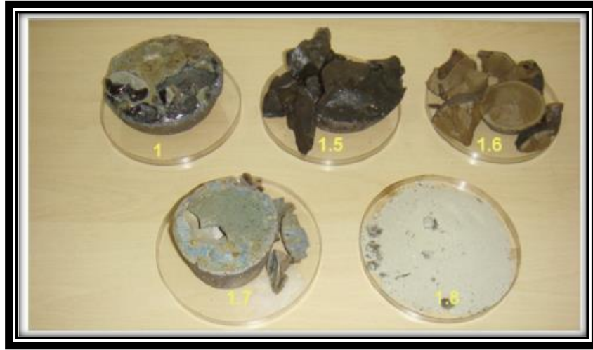
Şekil 5.5 Kuarsit Eklenerек Farklı Bazıklıkteki Pota Cürufları [37]
