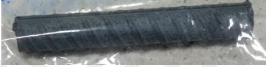
Şekil 7.5 16 mm Çap 100 mm Boy Kesilen Numune Örneği
