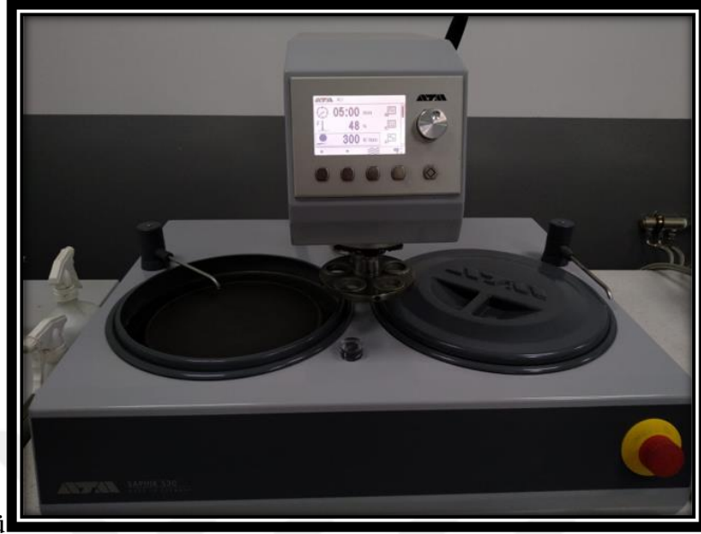
řekil 7.9 Numuneleri Zımparalamak İin Kullanılan Zımpara Cihazı
