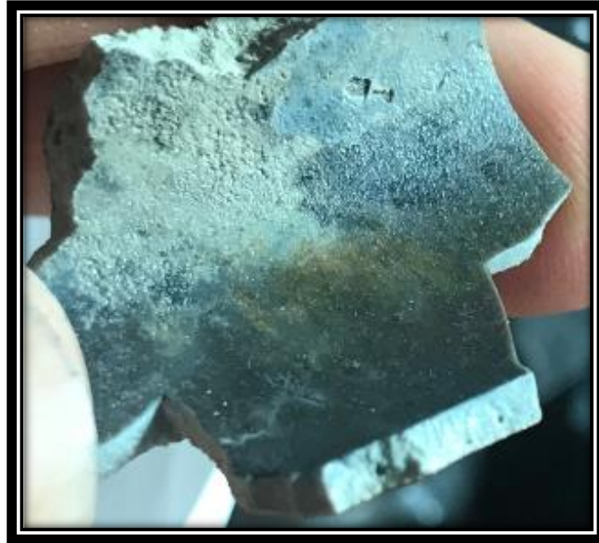
Şekil 7.15 Pota Cürufuna 80 kg Kolemanit Katıldıktan Sonraki Cüruf
