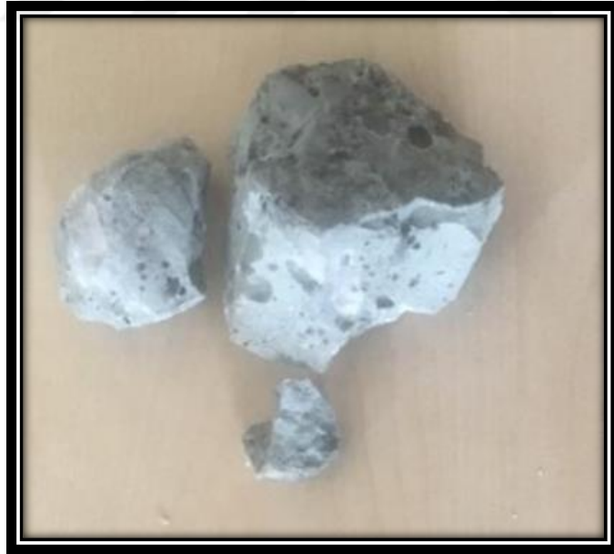
Şekil 7.3 40 kg Kolemanit Kullanılarak Elde Edilen ve Soğuduktan Sonra Kompakt Cüruf
