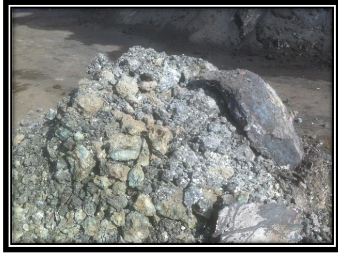
Şekil 7.4 60 kg Kolemanit Katılarak Üretilen Çelik Cürufunun Kompakt Yapısı
