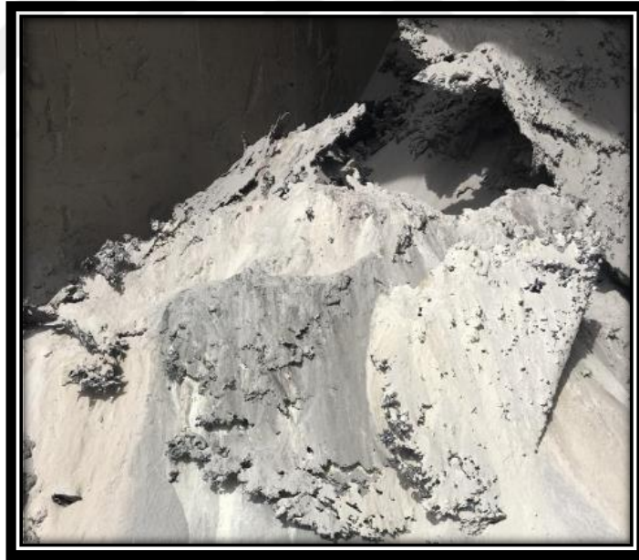
Şekil 7.1 Kolemanitsiz Elde Edilen ve Soğuduktan Sonra Tozlaşan Cüruf
