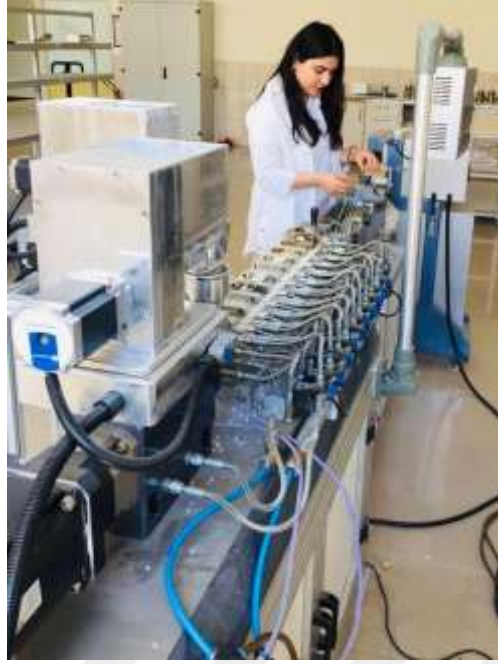
Fotoğraf 7.3. Ekstrüderde kompaund üretiminden görünüm
