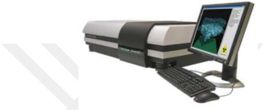
Fotoğraf 6.6. Bruker marka mikro tomografi cihazı (URL-17)
