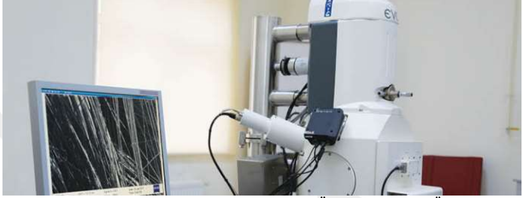
Fotoğraf 6.7. SEM görüntüleme cihazı (Niğde Ömer Halisdemir Üniversitesi Merkezi Araştırma Laboratuvarı)
