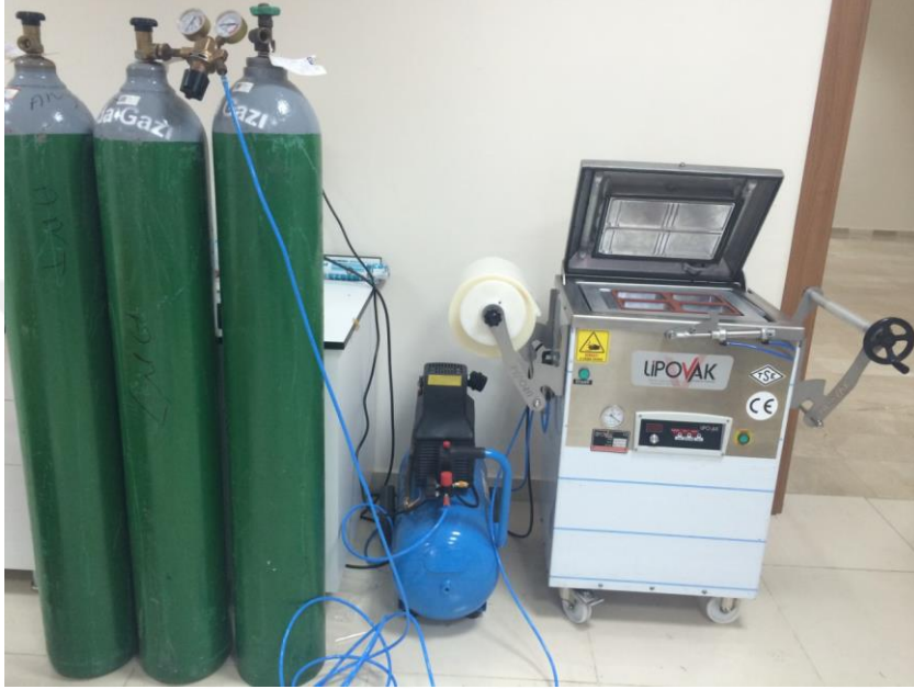
Şekil 3.5. Örneklerin paketlenmesinde kullanılan MAP ünitesi
