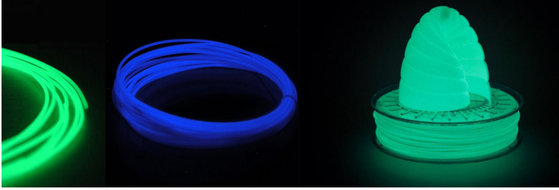
Resim 13 - Sıcaklık ve Işığa Duyarlı PLA Filamenti İle Basılmış Örnekler
