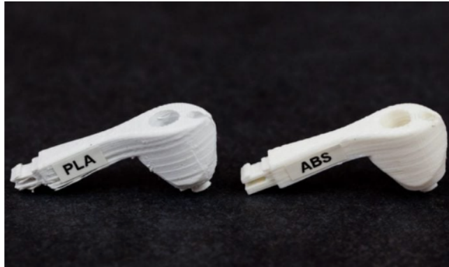
Resim 6 - ABS Filament & PLA Filamenti Karşılaştırması
