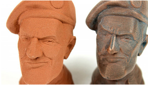
Resim 18 - Bronz, Pirinç ve Bakır Filamentleri İle Basılmış Örnekler
