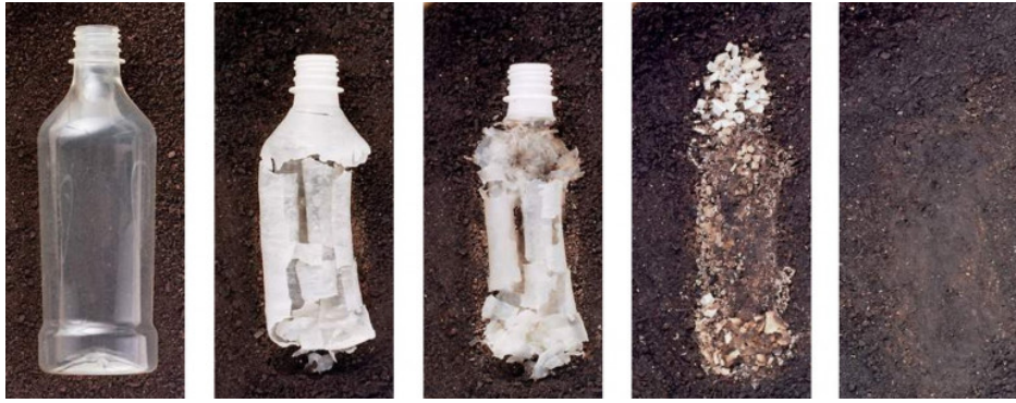
Resim 8 - PLA Filamentinin Doğada Çözülmesi
