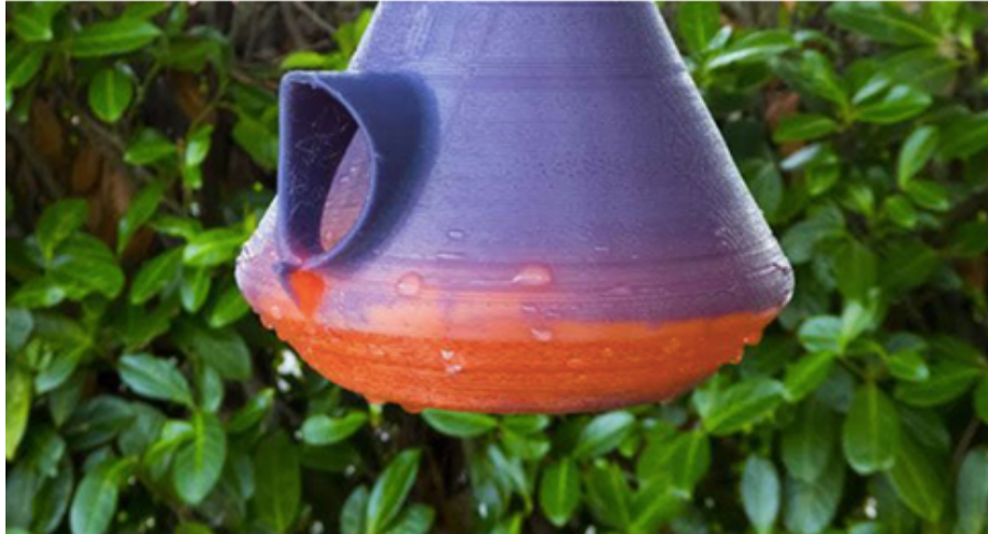
Resim 14 - Sıcaklık ve Işığa Duyarlı PLA Filamenti İle Basılmış Örnekler
