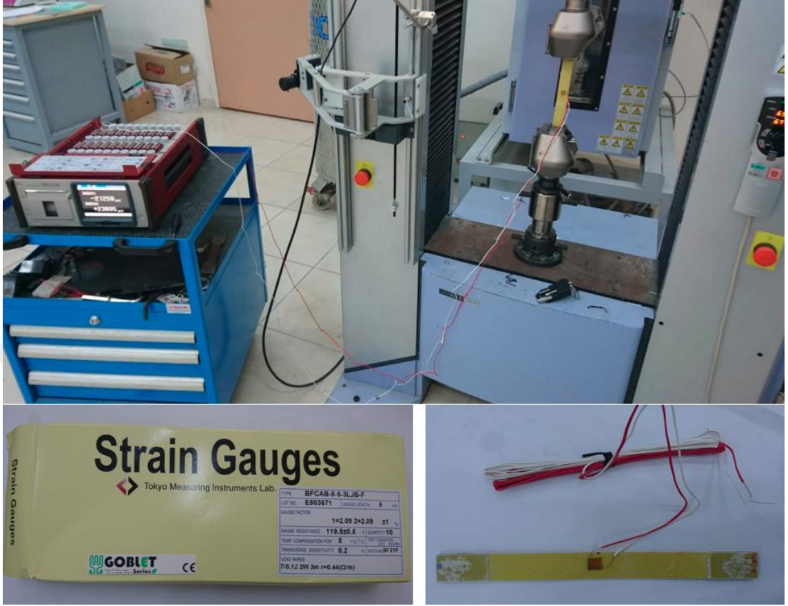
Şekil 3.26. Poisson oranlarını tespit etmek amacıyla kullanılan deney düzeneği ve strain gaugeler
