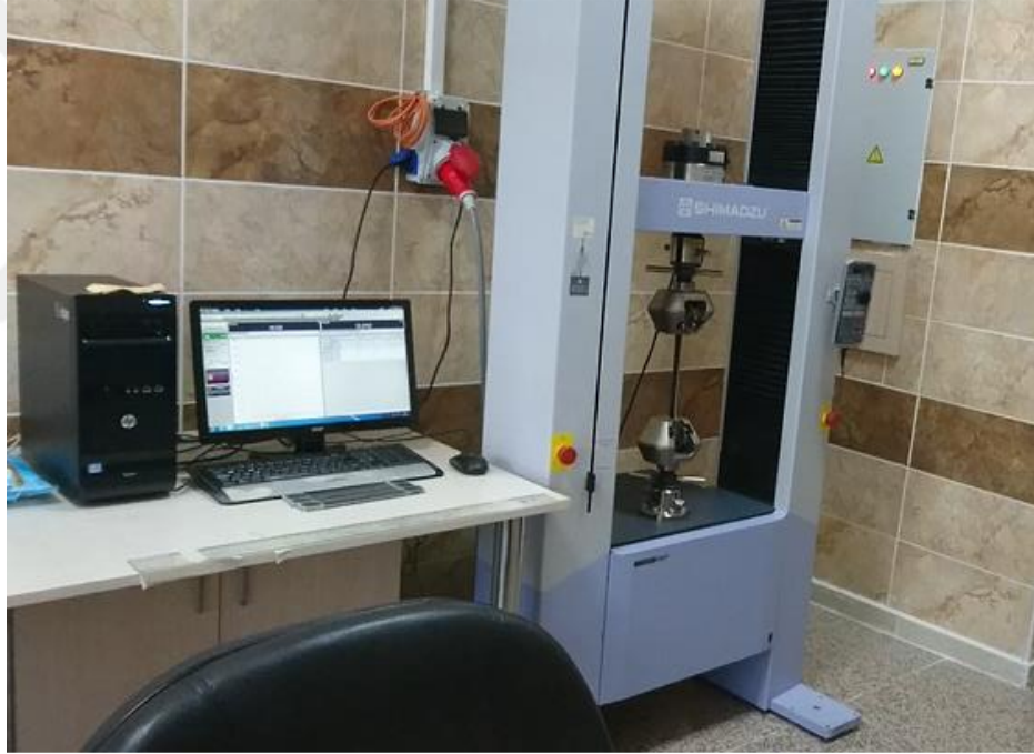
Şekil 3.28. Çekme testlerinin yapıldığı Shimadzu® AG-X 100 universal test cihazı
