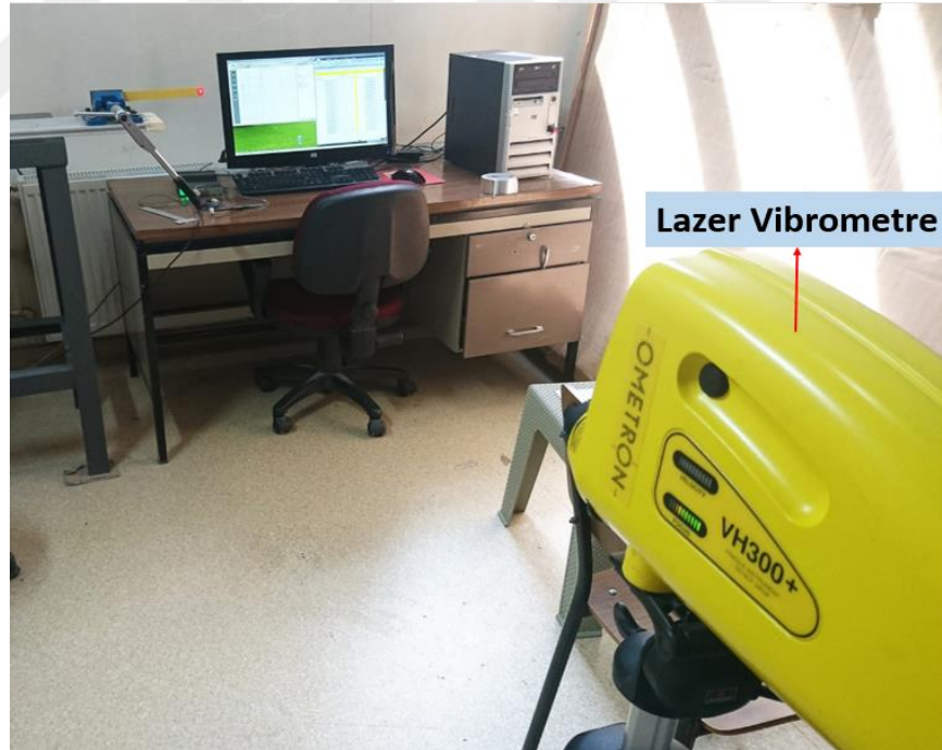
Şekil 3.21. Titreşim testi deney düzeneği
