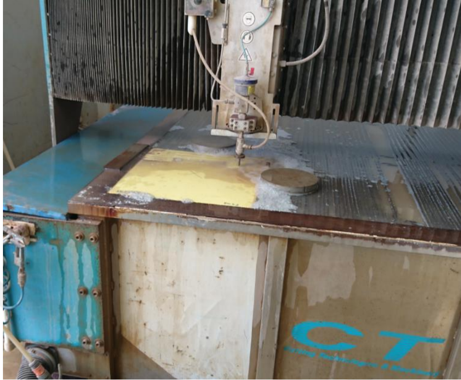
Şekil 3.14. Aramid plakadan su jeti ile test numunesi kesme işlemi
