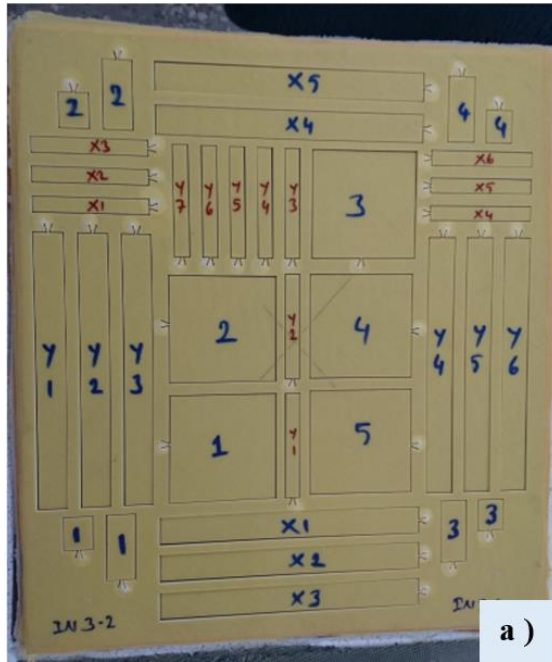
Şekil 3.15. a) Su jeti ile kesilmiş örnek bir aramid plaka, b) Kesimden sonra etiketlenerek gruplandırılan test numuneleri
