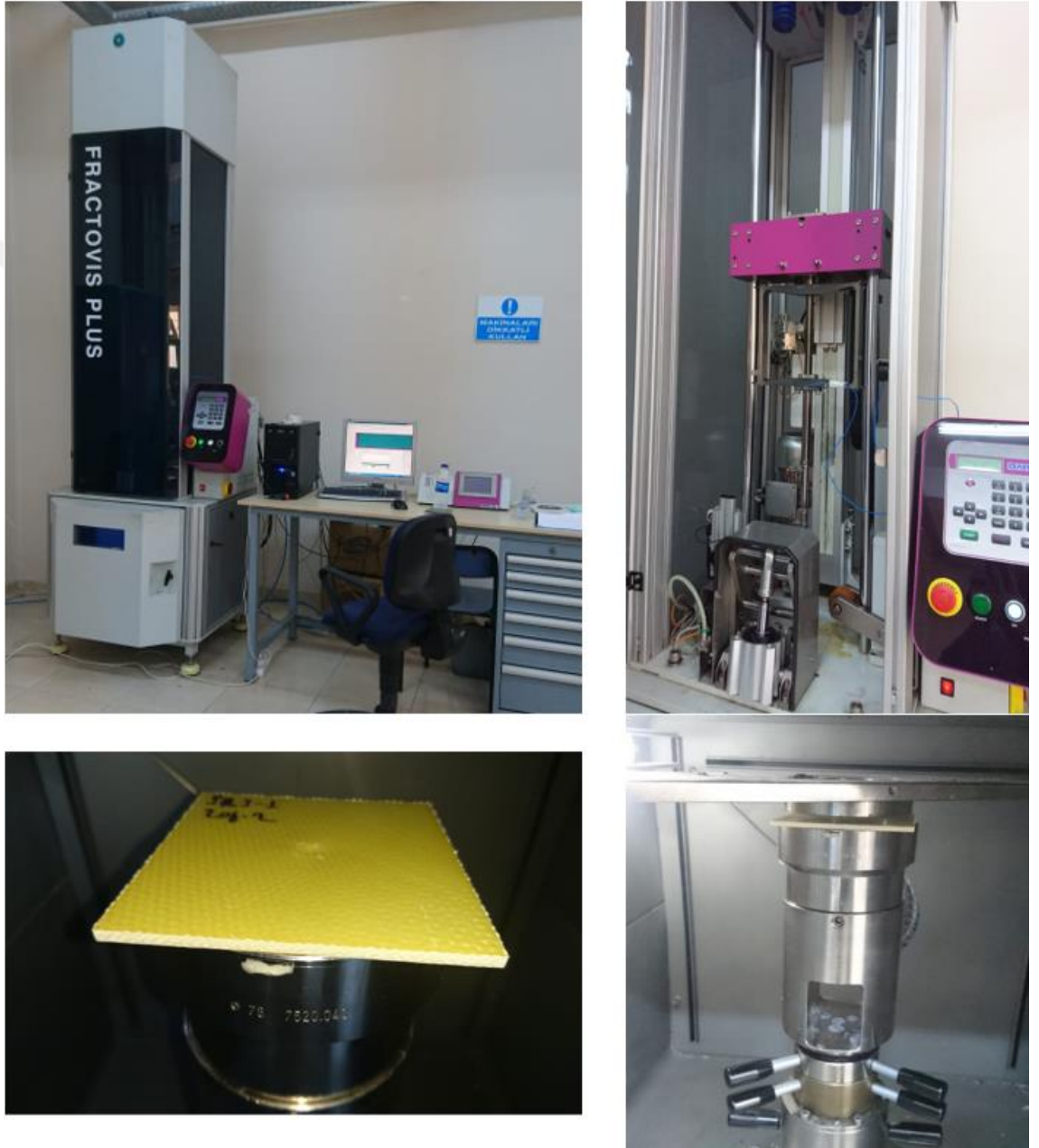
Şekil 3.33. CEAST Fractovis Plus® düşük hızlı darbe test cihazı
