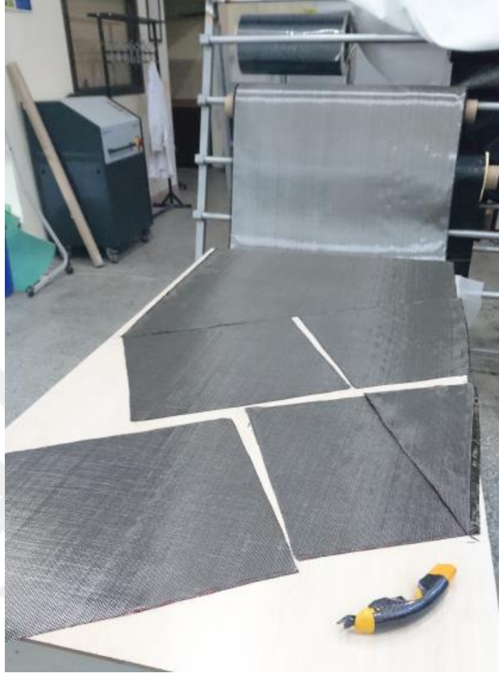
Şekil 3.3. Farklı yönlenme açısına sahip plakalarda kullanılan elyaf kumaşların kesilmesi
