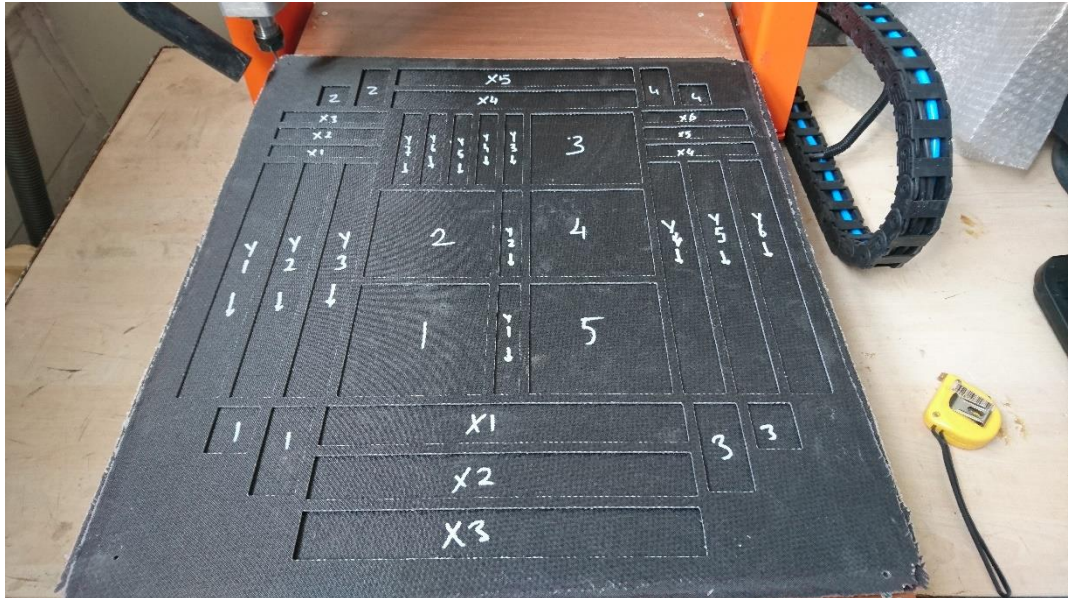
Şekil 3.13. Karbon plakadan CNC Router ile test numunesi kesme işlemi
