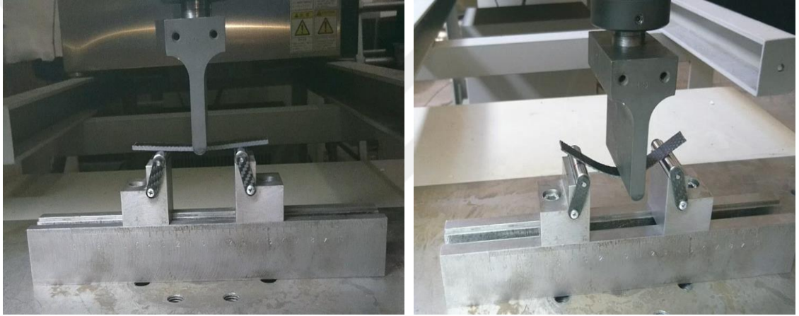
Şekil 3.31. a) Üç nokta eğilme test düzeneği, b) Kuvvetin etkisiyle numunenin bükülmesi
