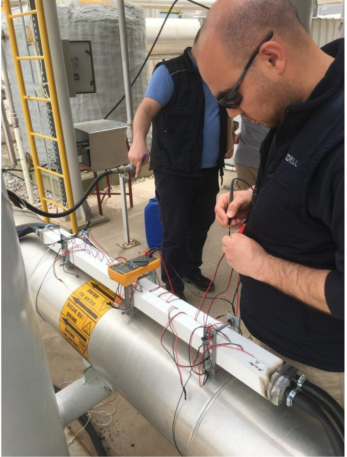
Şekil 6.8. Peltierlerden üretilen enerji değerlerinin ölçülmesi
