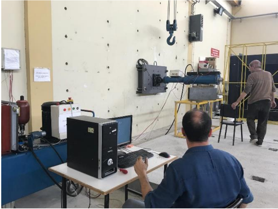
Şekil 3.24 Aktivatörün yerleştirilmesi ve gerekli kontrollerin yapılması (Kişisel arşiv, 2018)
