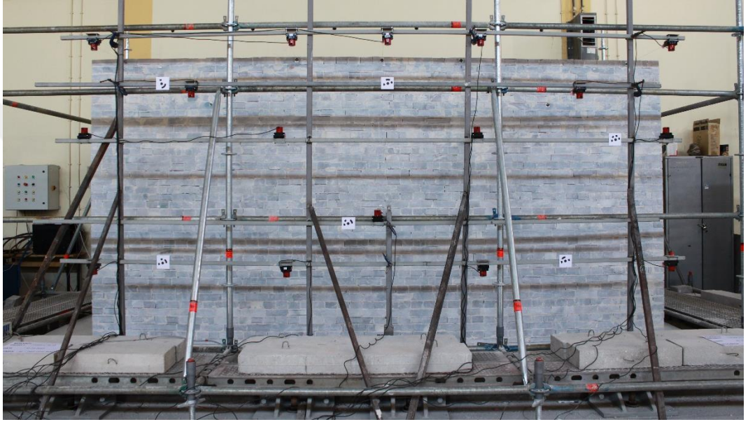
řekil 3.44 S2 numunesi dzlemdiř yarı-statik test ortamının genel grnm (Kiřisel arřiv, 2019)
