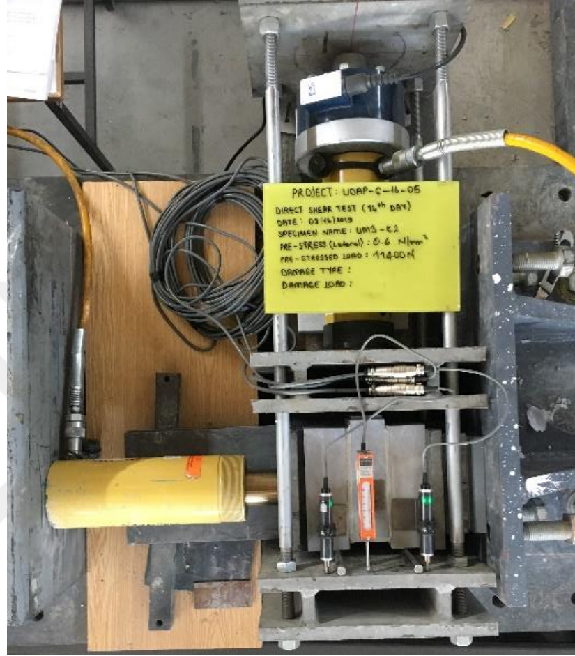
Şekil 3.19 Başlangıç kayma dayanımı tayini test düzeni (Kişisel arşiv, 2019)
