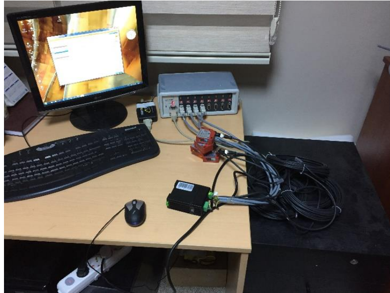
Şekil 3.27 Sensörlerin veri toplama sistemine bağlanması ve kalibrasyonu (Kişisel arşiv, 2019)
