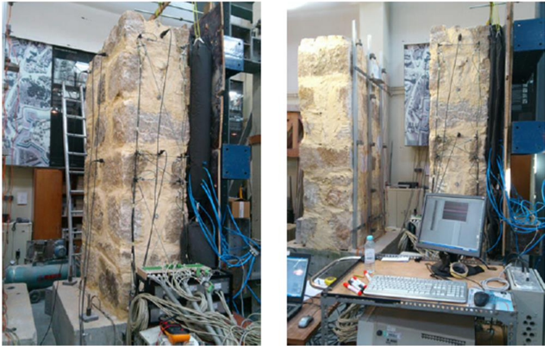
Şekil 2.4 Çok tabakalı duvarın alt sistem testleri (Ferreira ve diđer., 2015)
