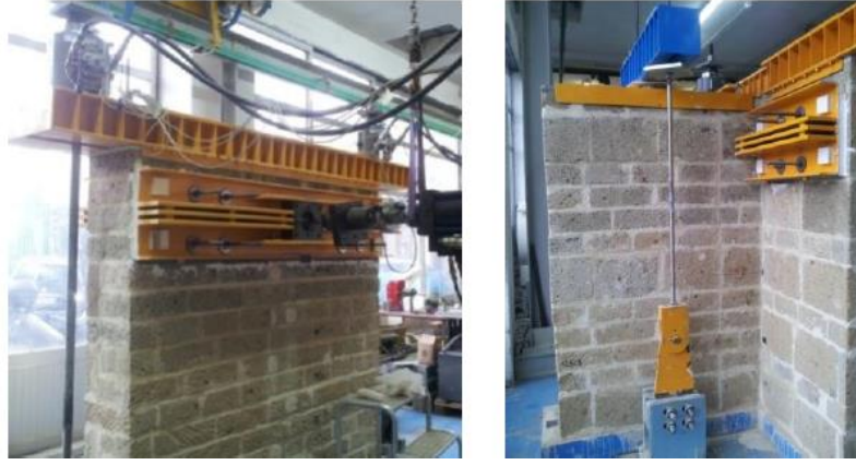
Şekil 2.5 Tam ölçekli iki yapraklı yığma duvar numuneleri üzerinde deplasman kontrollü monotonik ve çevrimsel yükleme testleri (Maddaloni ve diğer., 2016)
