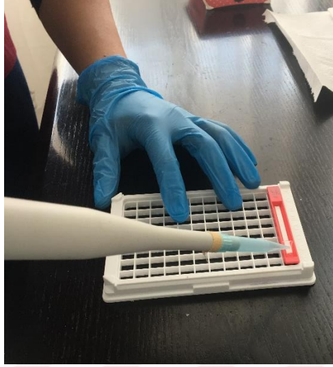
Resim 40. Hazırlanan yıkama solüsyonu kaset üzerine yayılması.
