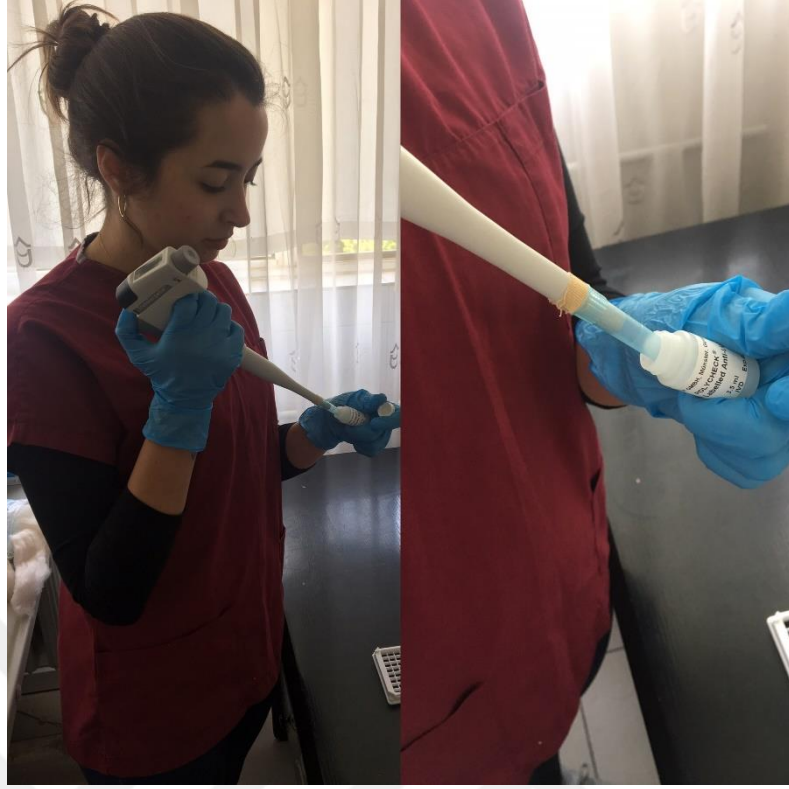
Resim 46. Kasetin haznesine, beyaz kapaklı streptavidin konjugat solusyonundan ilave edilmesi.
