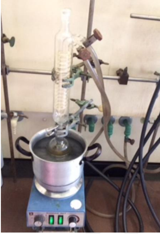
Resim 6.2. Amino selüloz eldesi için deney düzeneği
