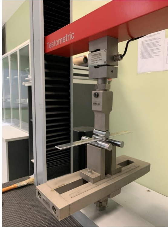
Şekil 3.21 Enine eğme test numunesinin yerleştirilmesi
