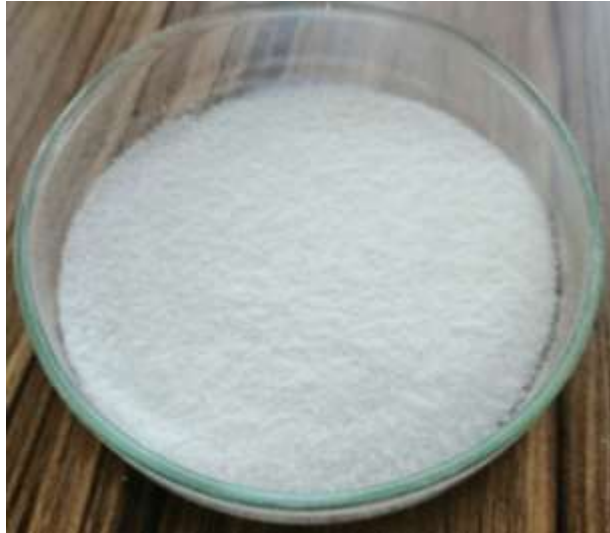
Şekil 3.2. Kuru ve öğütülmüş polikarboksilat esaslı polimer adsorbent
