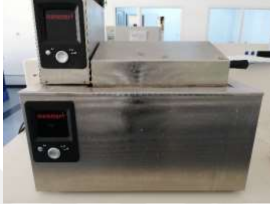
Şekil 3.3. Adsorpsiyon deneylerinin yürütüldüğü çalkalamalı su banyosu
