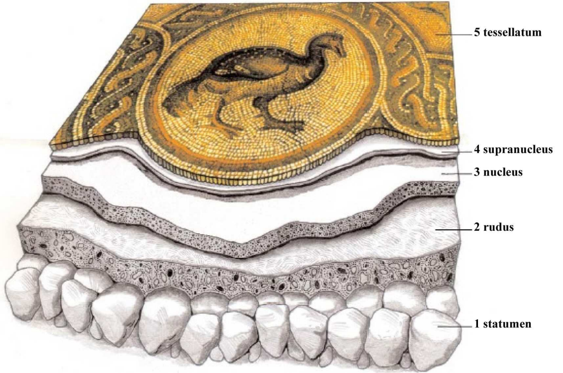
Şekil 2: Mozaik taban döşemesi tabakaları
