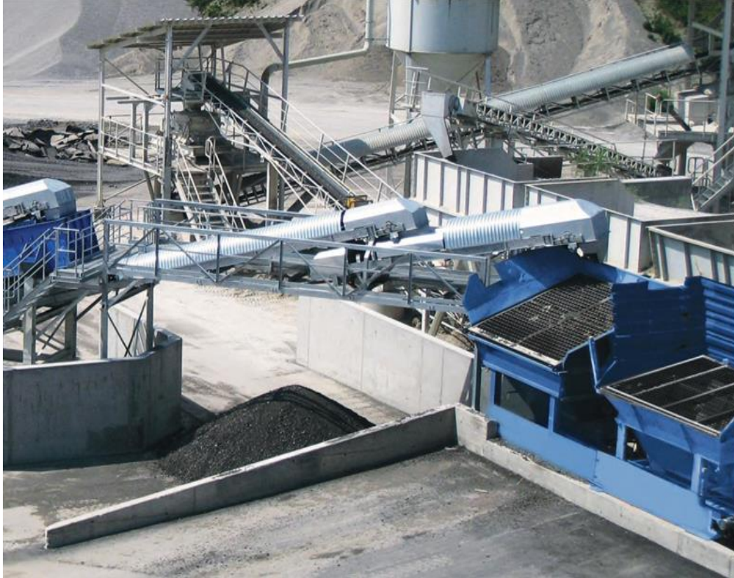
Şekil 3.2 : Agrega boyutlarının düşürülmesi için kullanılan konkasörler.
