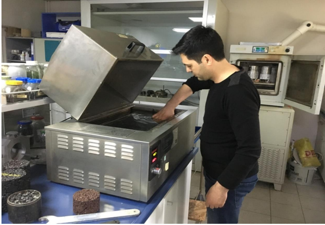
Şekil 3.22 : Koşullu numunelerin suda bekletilmesi görünümü.
