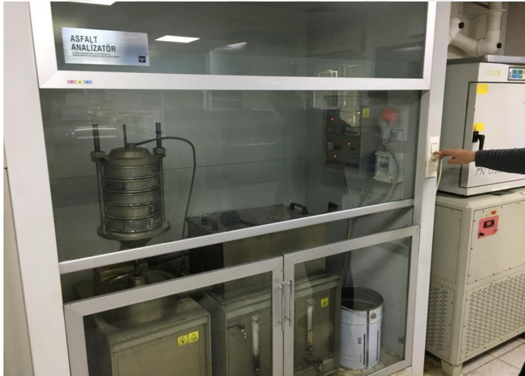
Şekil 3.3 : Asfalt analizatör makinesi görünümü.
