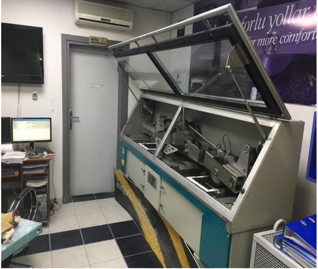
Şekil 3.26 : Hamburg modeli tekerlek izi test makinesi görünümü.
