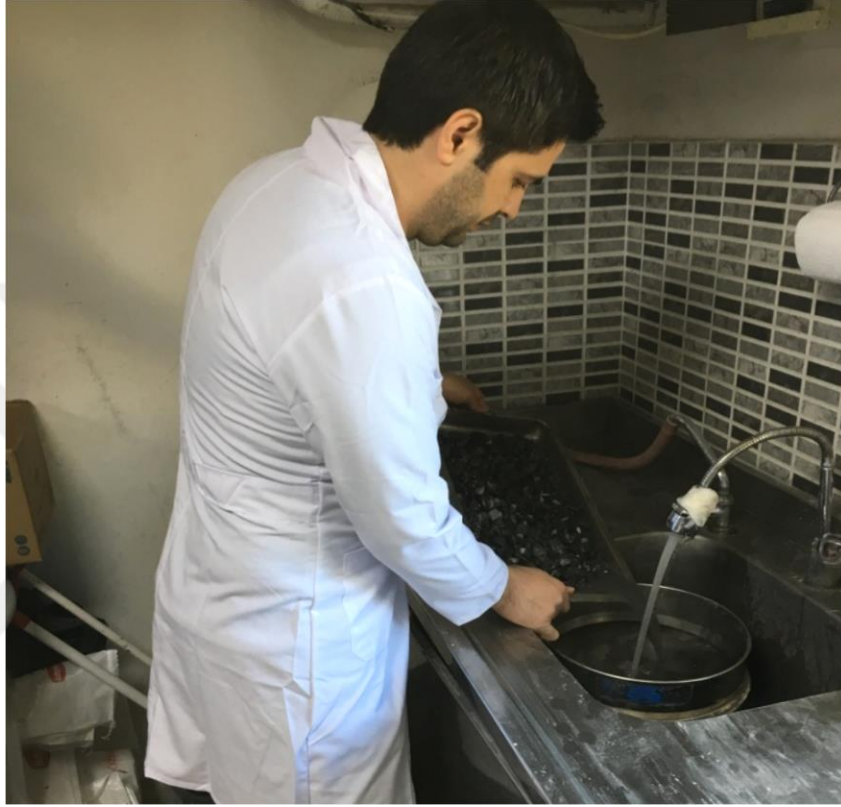
Şekil 3.4 : Rap Malzemesi Agregalarının Yıkanması.
