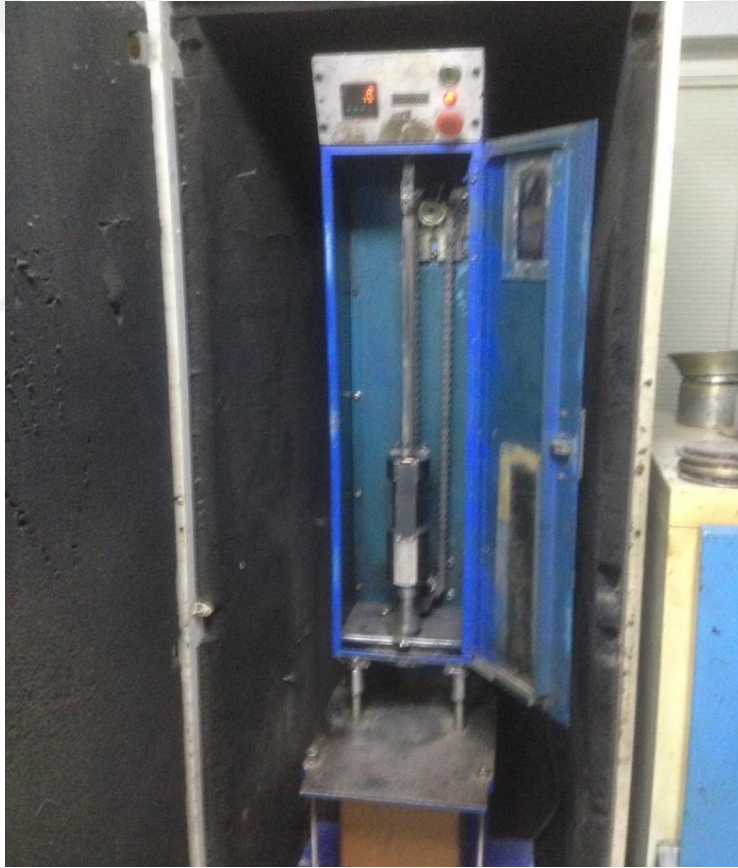
Şekil 3.10 : Deney numunelerinin sıkıştırıldığı Marshall Tokmağı.
