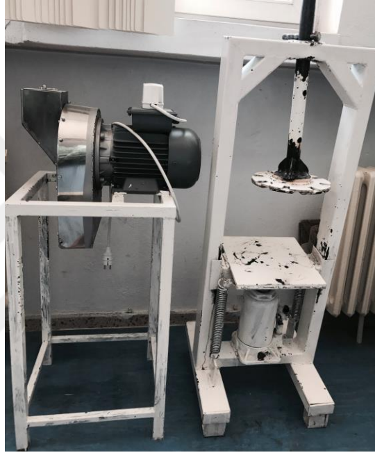
Şekil 3.2.1. Kırıcı ve manuel soğuk pres
