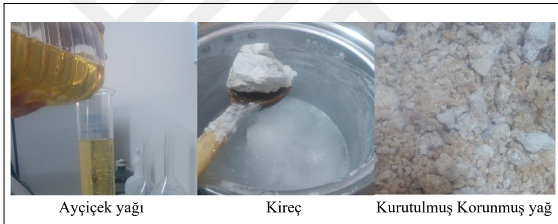
Şekil 3.3. Kireçle muamesesi sonucu elde edilen korunmuş ayçiçek yağı
