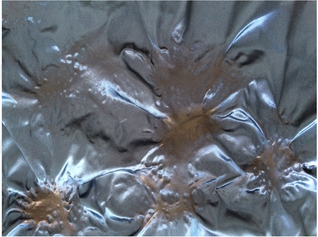
Resim 64: Polyester saten, ısı tabancası ile başarısız deneme
