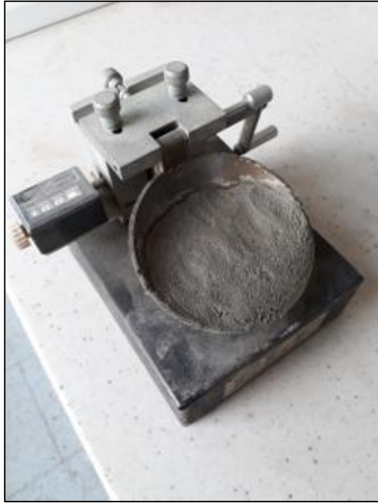
Şekil 2.4. Likit limit deneyine ait bir görüntü.
