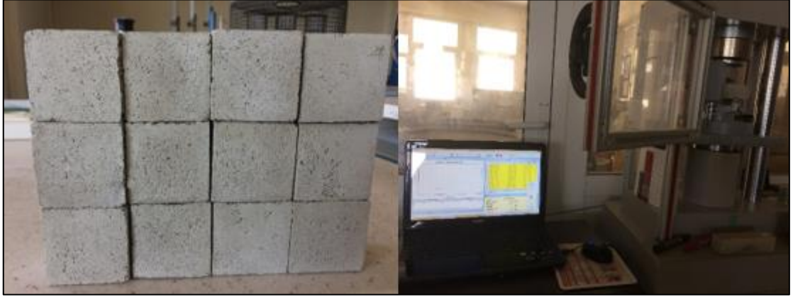
Şekil 2.10. Basınç dayanımı testinde numuneler kırılmadan önceki görüntüler.
