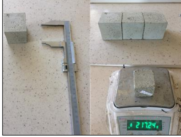
Şekil 2.15. Birim hacim ağırlık deneyine ait görüntüler.
