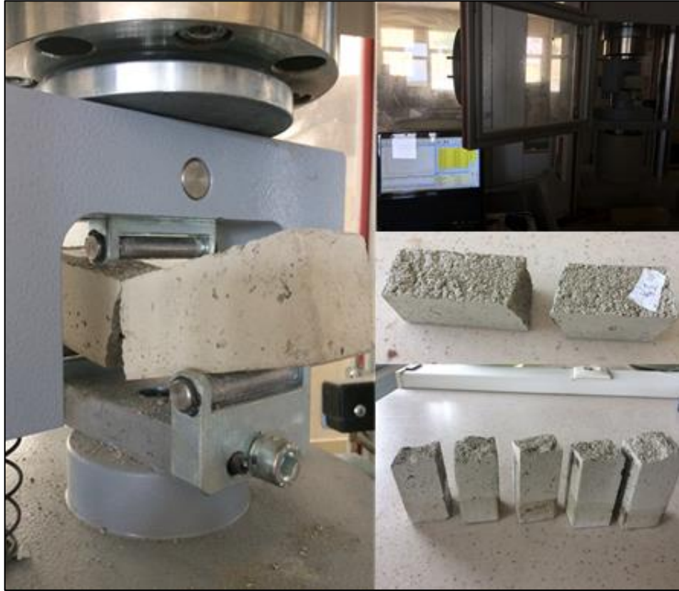
Şekil 2.13. Eğilme dayanımı testinde numuneler kırıldıktan sonraki görüntüler.
