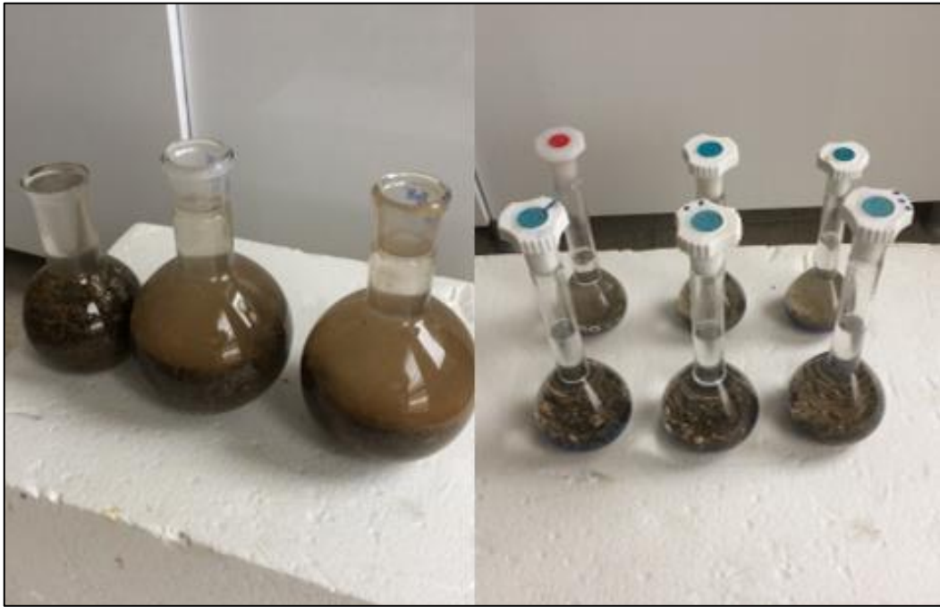
Şekil 2.7. Özgöl ağırlık deneyine ait görüntüler.
