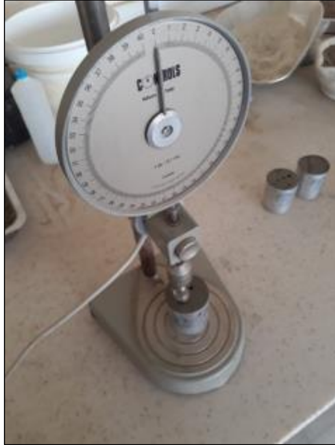
Şekil 2.3. Koni penetrasyon deneyine ait bir görüntü.
