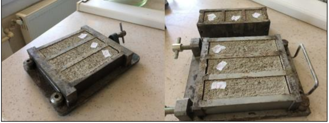
Şekil 2.12. Eğilme dayanımı testinde numuneler kırılmadan önceki görüntüler.
