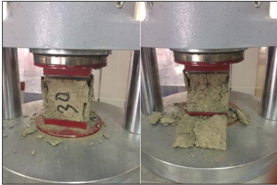
Şekil 2.11. Basınç dayanımı testinde numuneler kırıldıktan sonraki görüntüler.
