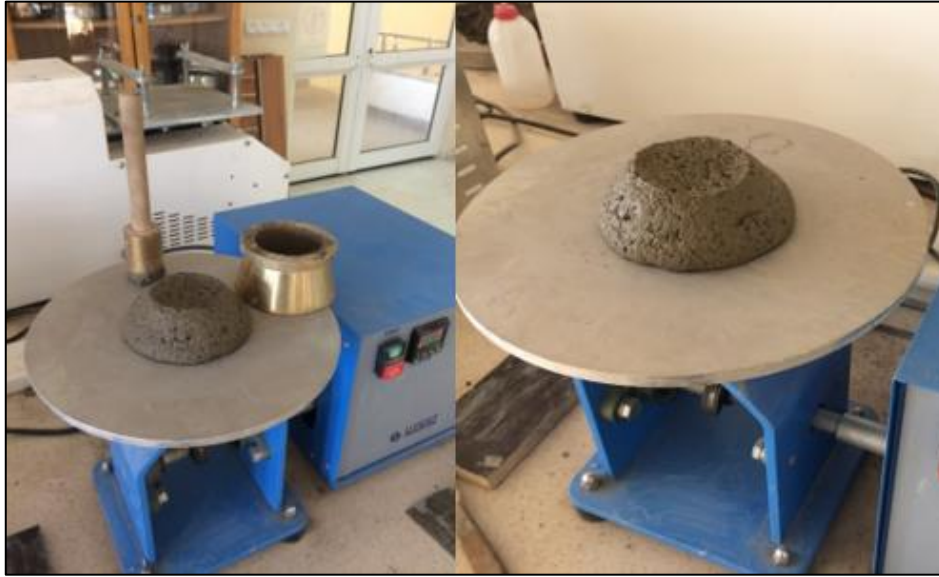
Şekil 2.9. Yayılma tablası deneyine ait görüntüler.
