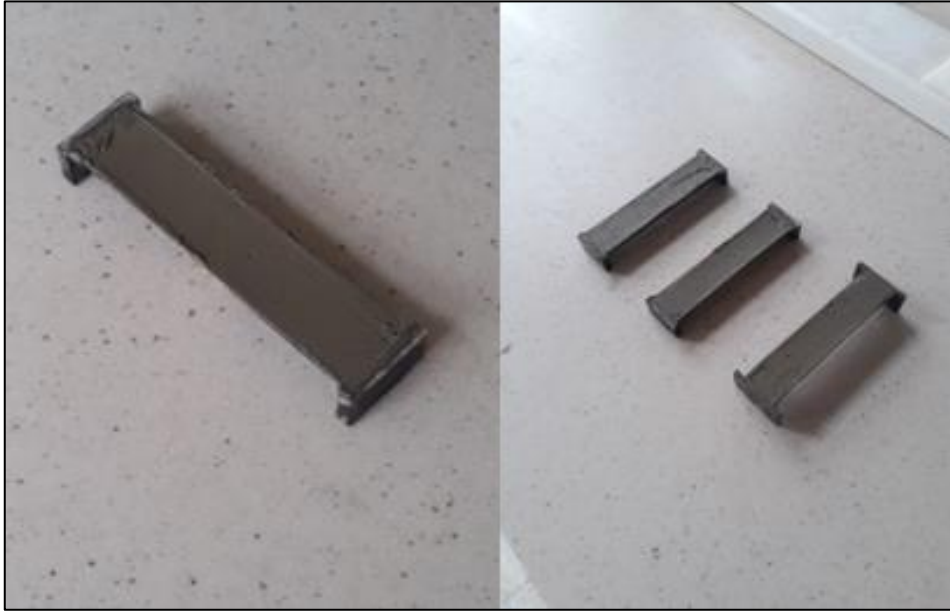
Şekil 2.5. Lineer büzülme deneyine ait görüntüler.
