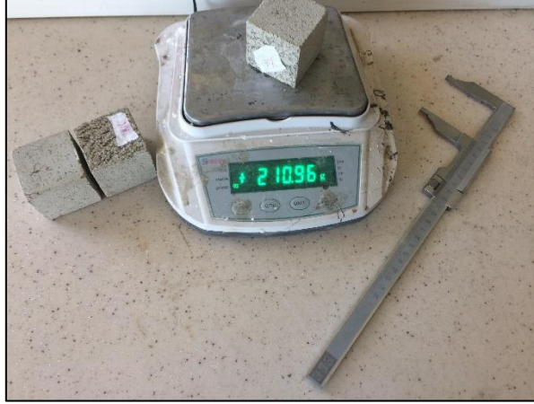
Şekil 2.14. Kütlece nem kaybının bulunması deneyine ait bir görüntü.
