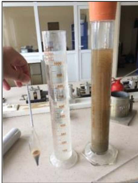
Şekil 2.2. Hidrometre deneyine ait bir görüntü.
