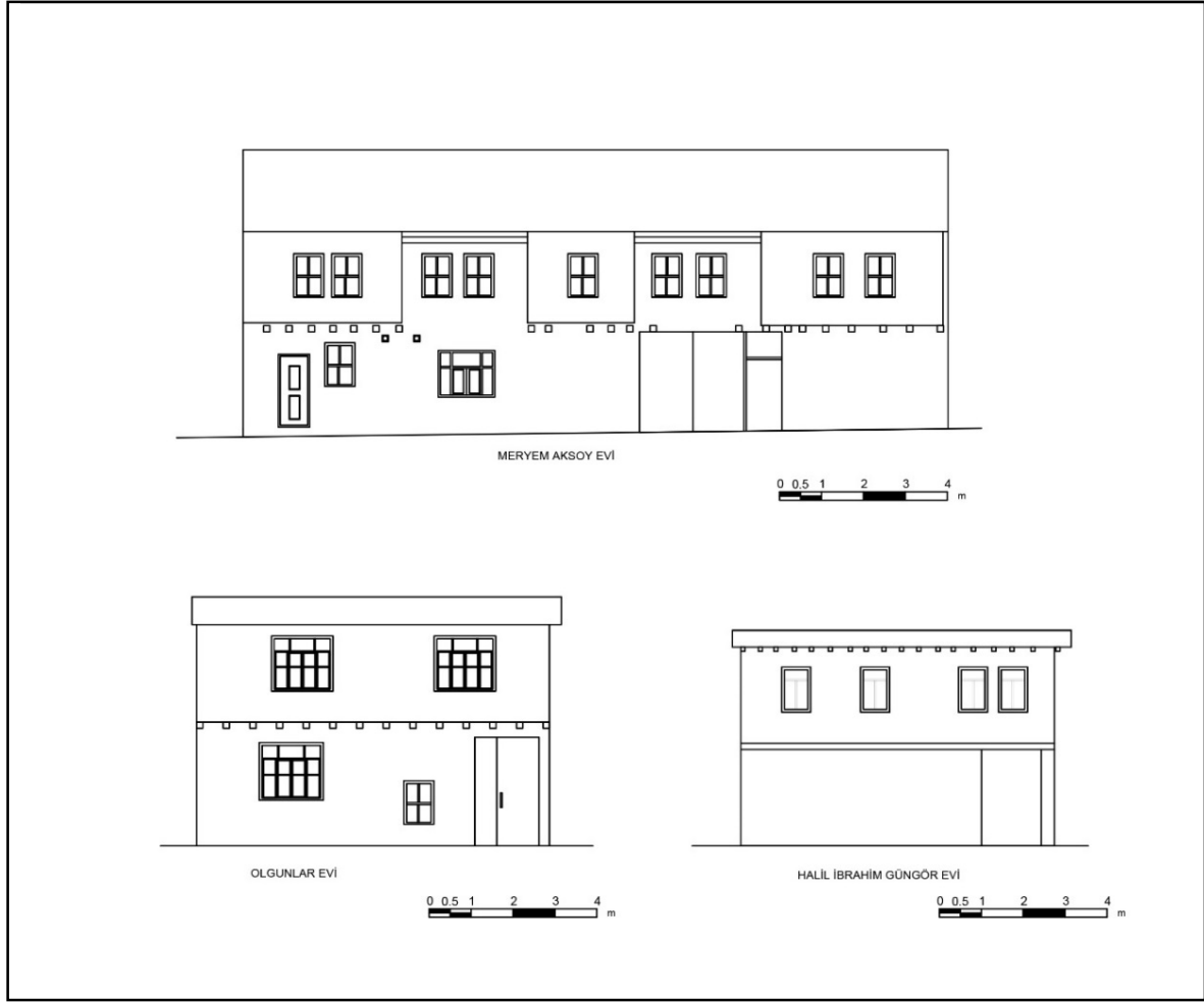
Şekil 5.11. Zemin katı boşaltılmış konutlar
