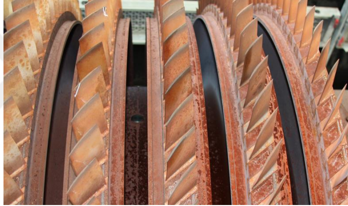
Şekil 2.26 Kanatçık Korozyon Örneği [51]
