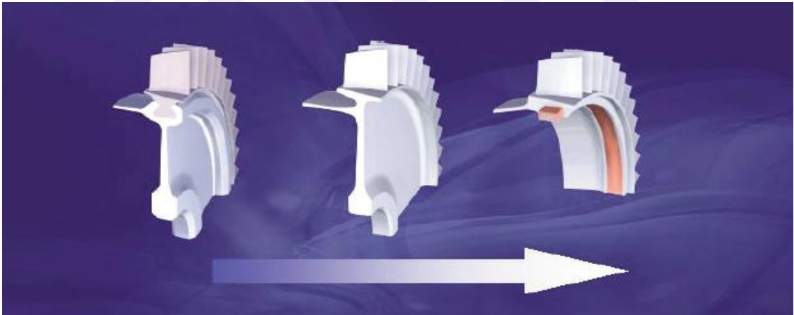
Şekil 2.12 Standart, Blisk ve Bling Teknolojisi [27]
