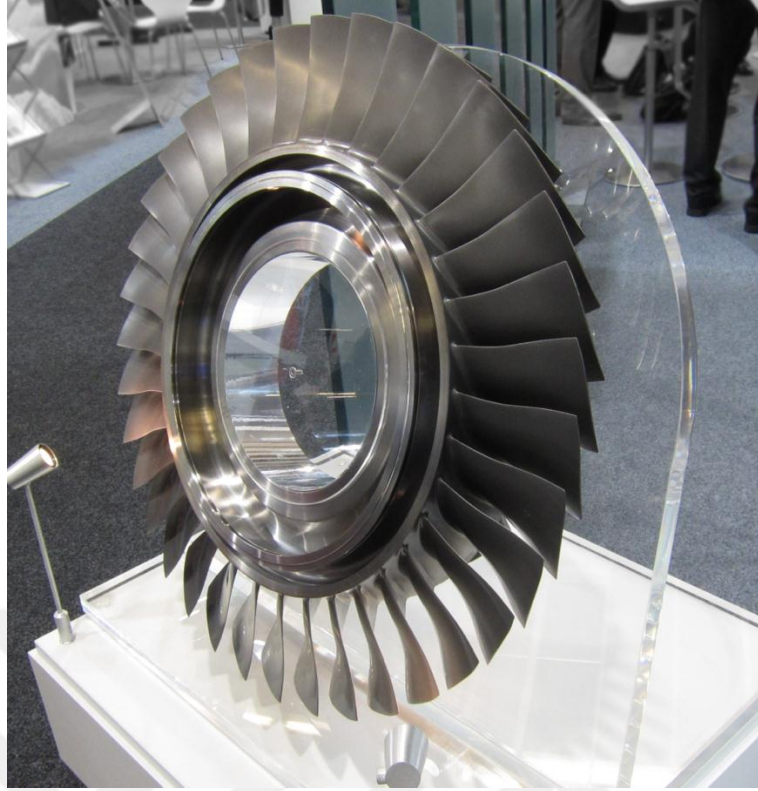
Şekil 2.10 3D CNC Frezeleme ile Üretilen Kompresör Blisk Örneği [26]
