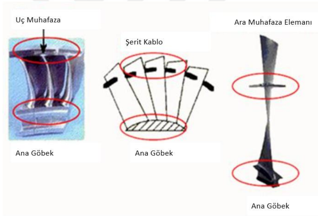
Şekil 3.14 Gaz Türbini Kanatçık Mekanik Bağlantı Titreşim Aktarım Çeşitleri [38]
