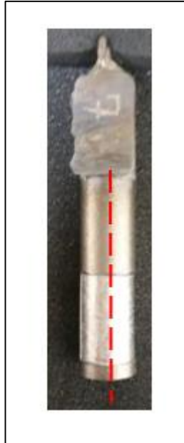
Şekil 4.3: Yüzey pürüzlülük ölçüm noktası.
