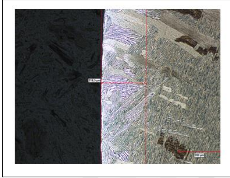
Şekil 4.29: D7 numunesinde alfa katmanı kalınlığı.
