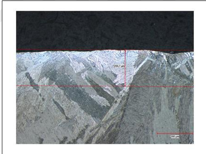
Şekil 4.4: D4 numunesinde alfa katmanı kalınlığı.
