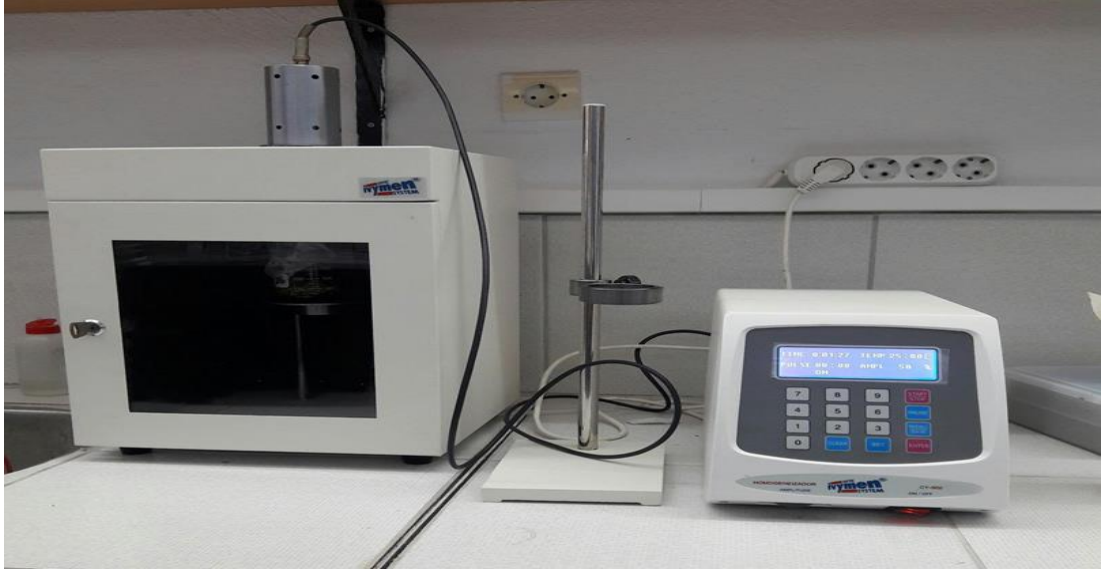
Şekil 2.1. Ultrases destekli ekstraksiyon sistemi
