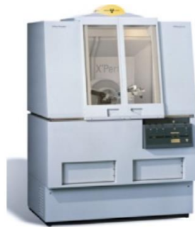
Şekil 3.3 X-ışını difraktometresi (XRD) cihazı, PANalytical X'Pert Pro powder [50]
