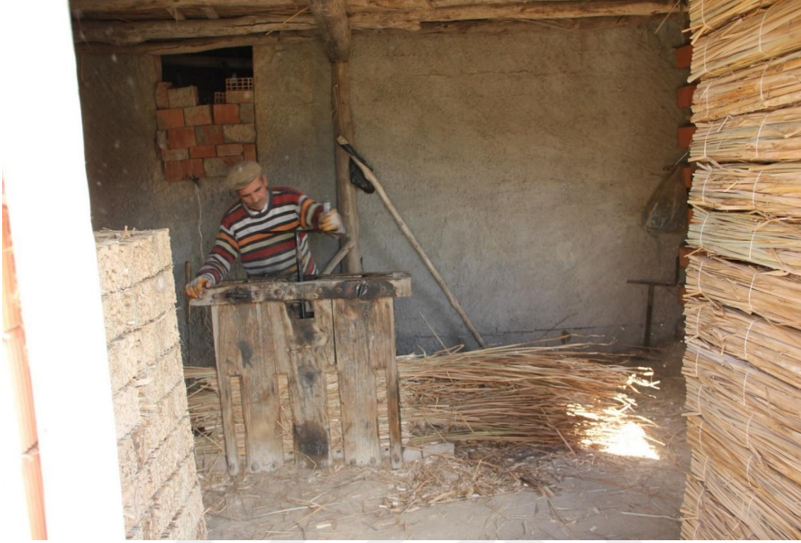
Schoenoplectus lacustris L. 'in atölyede kesilip birleştirilip iple bağlanarak sıkıştırılması-1
