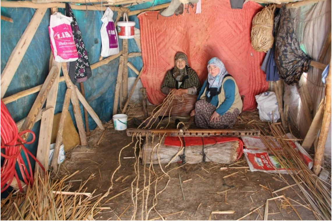
Typha angustifolia L. özünden yapılmış ipin dokumak üzere dokuma tezgahına geçirilmesi-1
