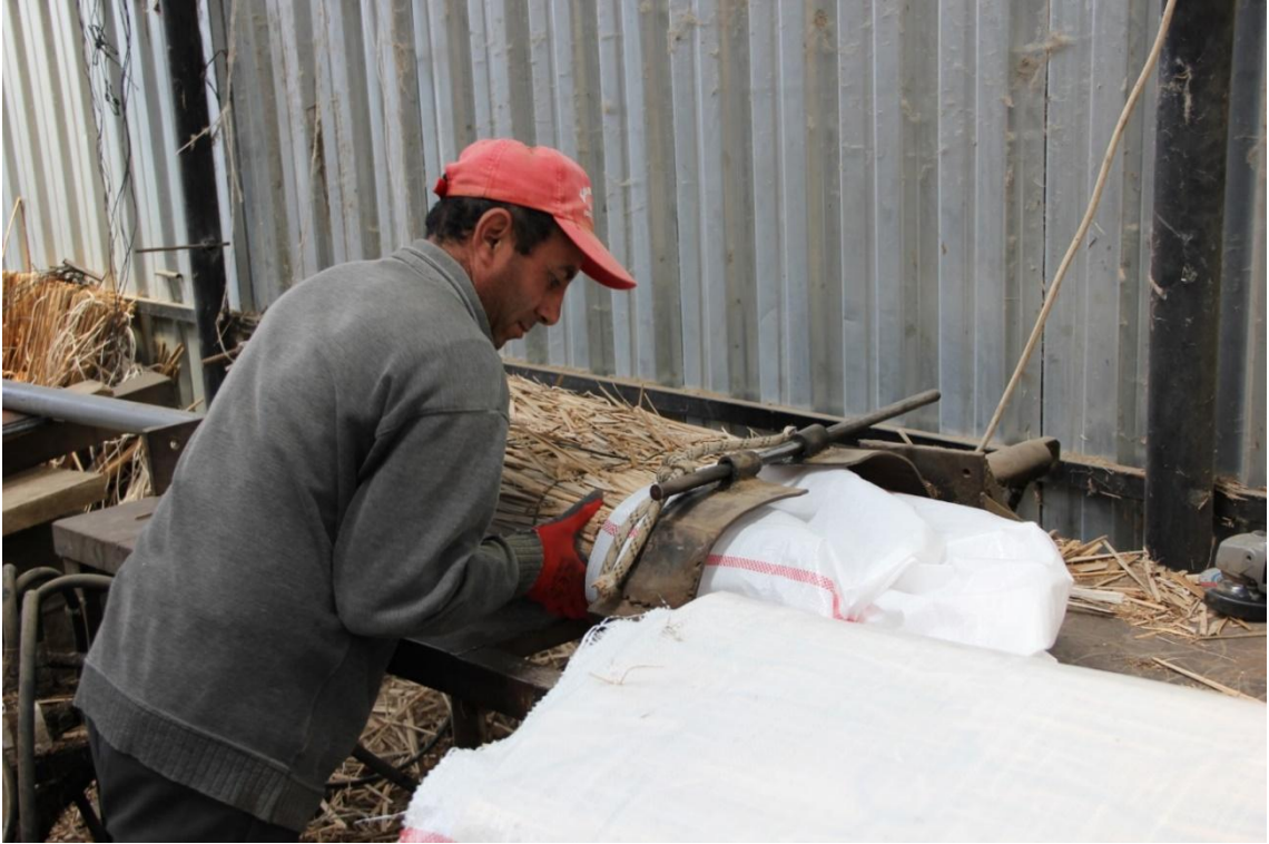
Schoenoplectus lacustris L. 'in yastık yapmak için çuvallara makinayla geçirilmesi-1
