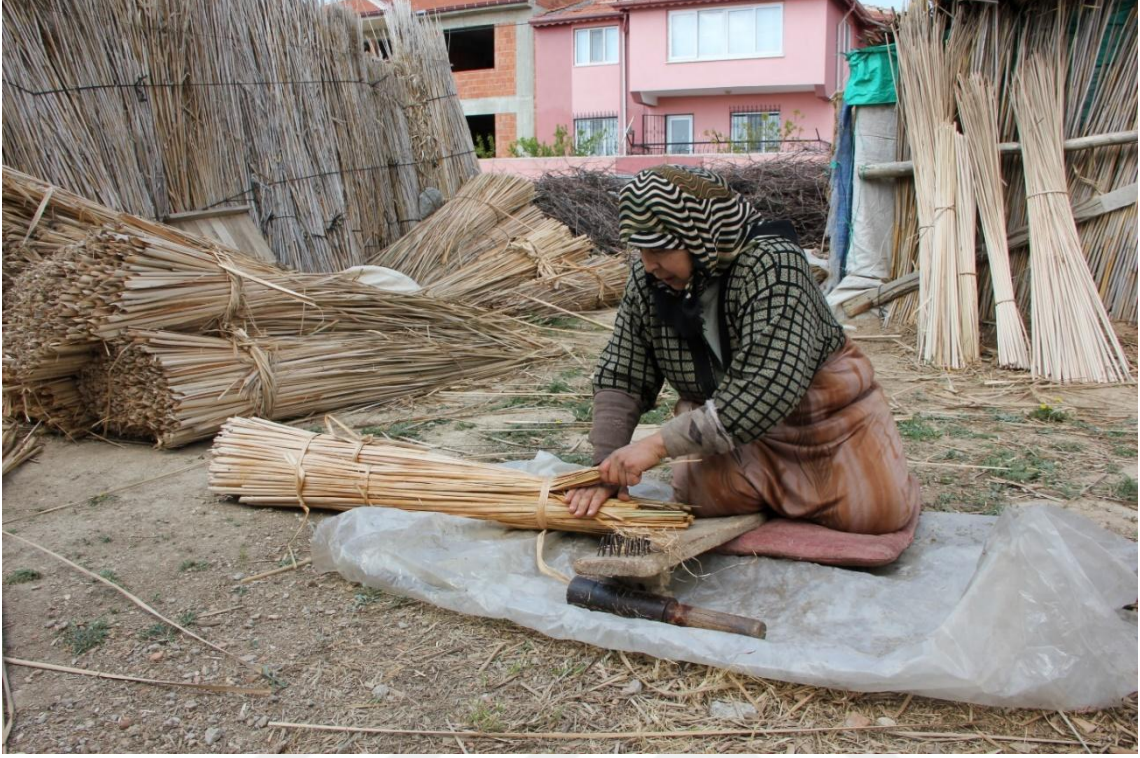
Typha angustifolia L. özünün kıvrılıp elde ip yapımında örülmesi-1
