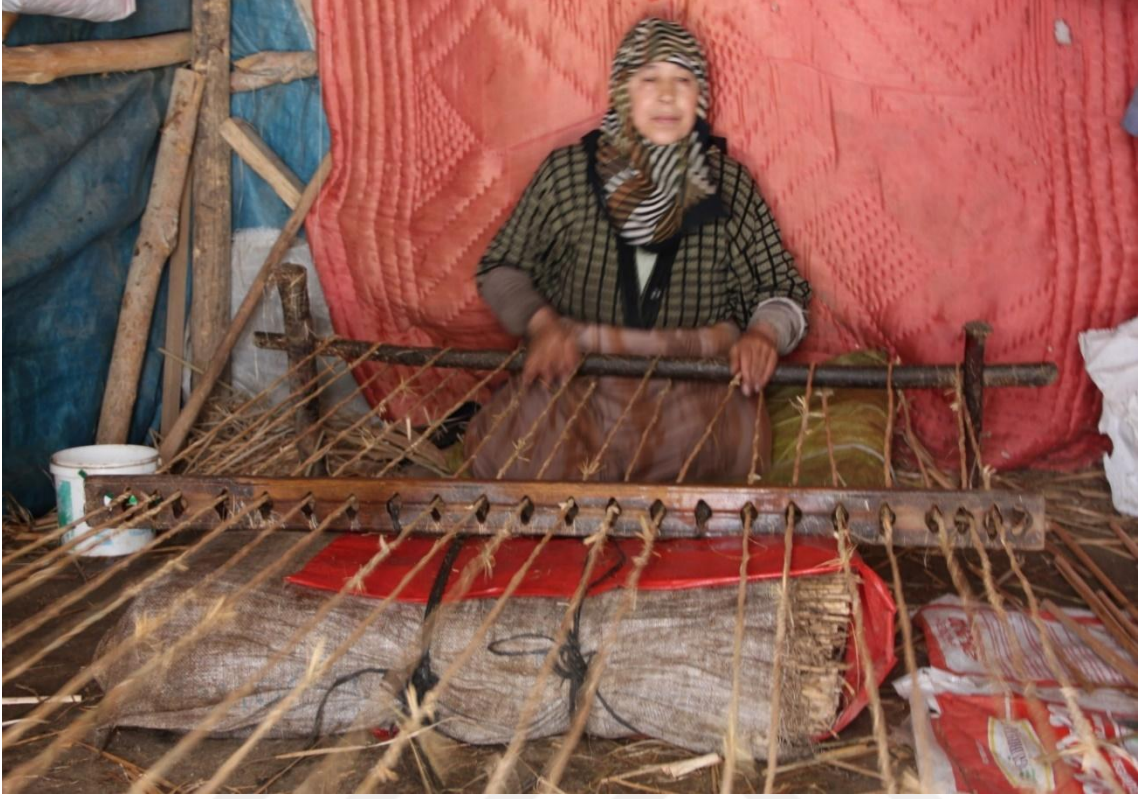
Typha angustifolia L. özünden yapılmış ipin dokumak üzere dokuma tezgahına geçirilmesi-2
