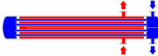
Şekil 1.15. Ters akışlı ısı değiştiricisinin gösterimi (Yakut, 2006)
