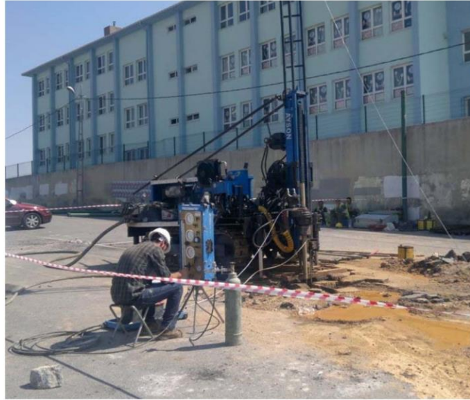
Foto:1: Dudullu İstasyonu SK-DUD-1 Sondaj Kuyusunda Presiyometre Deneyi Yapılması
