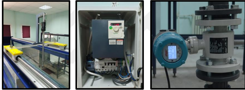
Şekil 3.4. Deneyde kullanılan cihazlar (a) Limnometre, (b) Hız kontrol cihazı, (c) Elektromanyetik debimetre
