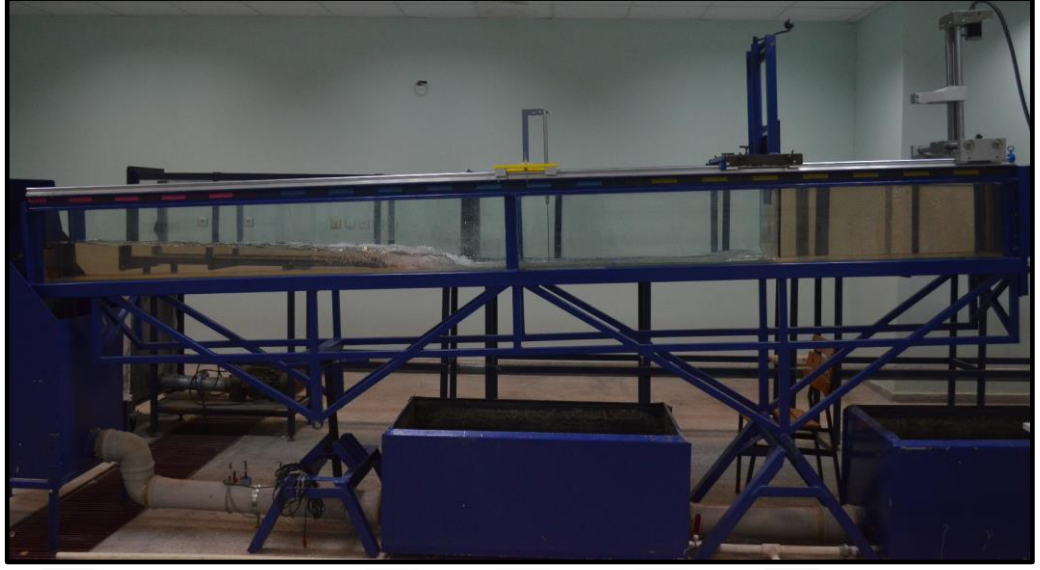
Şekil 3.3. Deneyde kullanılan açık kanal modeli
