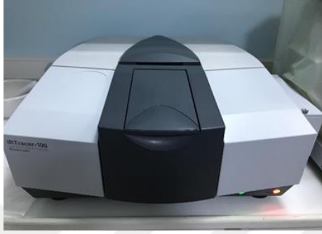
Şekil 2.25. Shimadzu IRTracer FT-IR analizi cihazı
