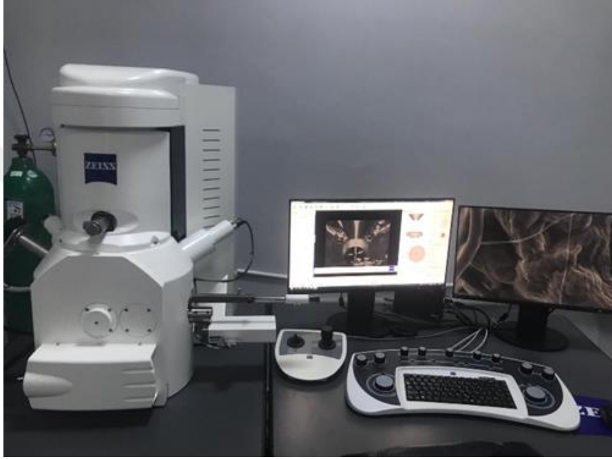
Şekil 2.27. Zeiss EVO MA10 taramalı elektron mikroskobu
