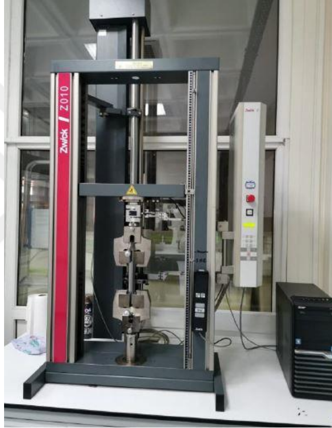
Şekil 2.24. Zwick Universal Z010 çekme cihazı
