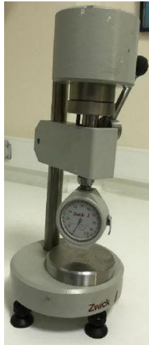
Şekil 2.26. Zwick/Roell analog shoremetre
