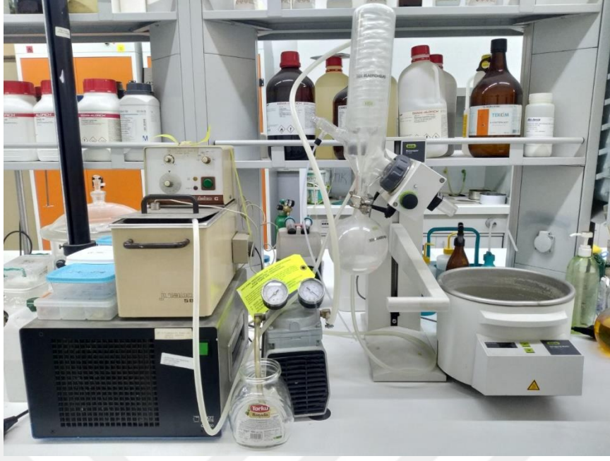
Şekil 2.28. Rotavapor® R100 evaporatör cihazı
