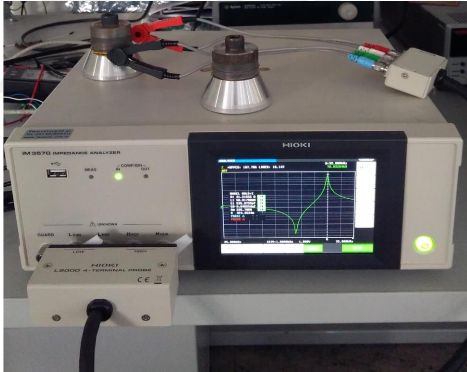
Şekil 4.6 : Empedans ölçümleri için laboratuvarda kurulan test düzeneği.
