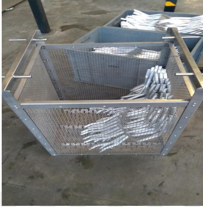
Şekil 5.17 : Yıkama sepeti genel görünümü.
