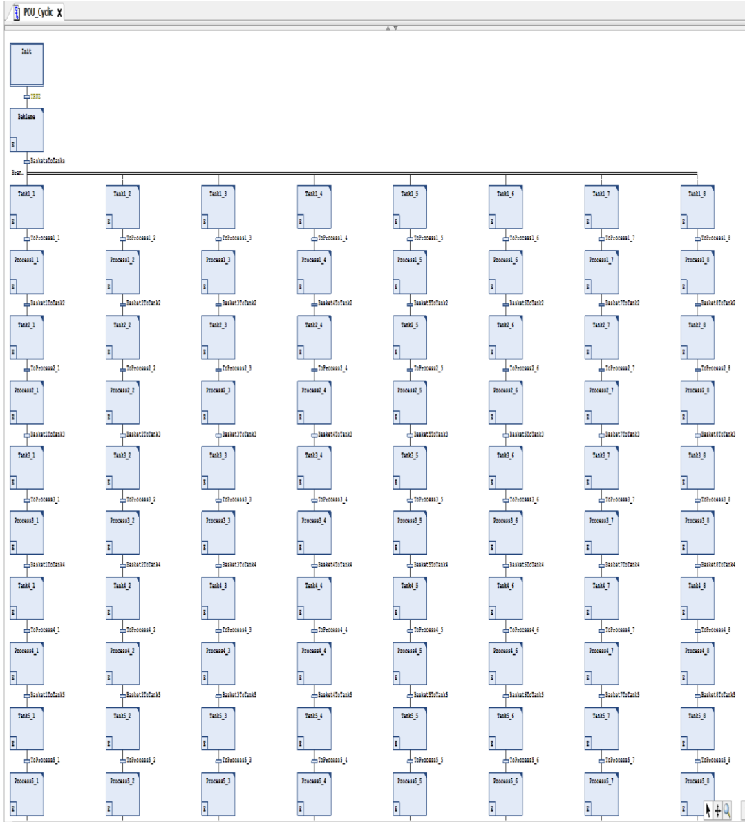
Şekil 5.29 : SFC programlama dili örneği.
