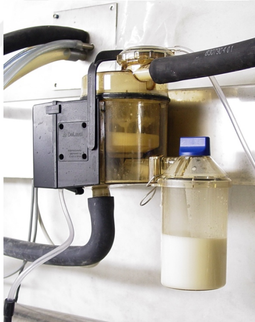
Şekil 3-23: Süt numunesi almak için kullanılan sistem [122]
