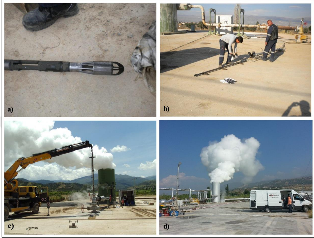
Şekil 4.9: Kuyu içi dinamik basınç ve sıcaklık ölçümü. a) Kuster marka PTS aleti. b) kuyuya gönderilmeden önce PTS aletinin lubrikatör içine yerleştirilmesi. c) Vinç yardımıyla lubrikatörün kuyu başına monte edilmesi. d) Mobil araca monte edilmiş makara sistemiyle PTS'in lubrikatör aracılığıyla kuyu içinde gönderilmesi ve dinamik basınç-sıcaklık ölçümlerinin yapılması.
