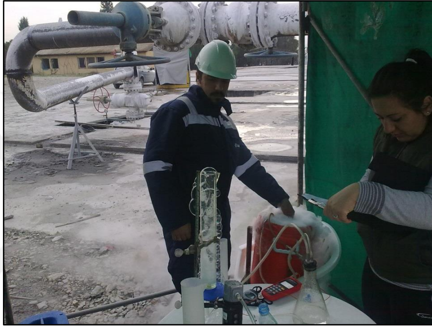
Şekil 4.4: KD9A kuyusunda kabarcık (bubbling) yöntemiyle gaz/buhar oranı ölçümü.
