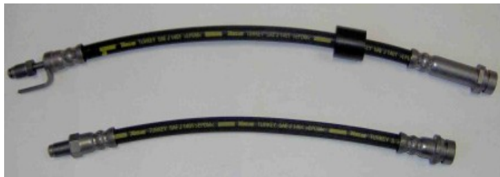
Şekil 7.5 Fren hortumu parçaları
