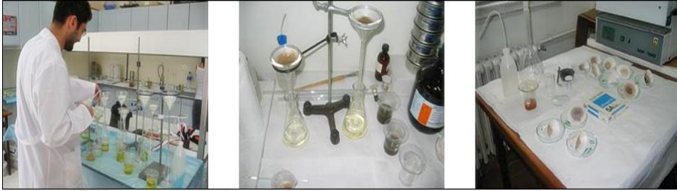
Şekil 4.6. Örneklere Uygulanan Asitle Müdahale (Solda), Süzme (Ortada) Ve Kurutma (Sağda) İşlemleri
