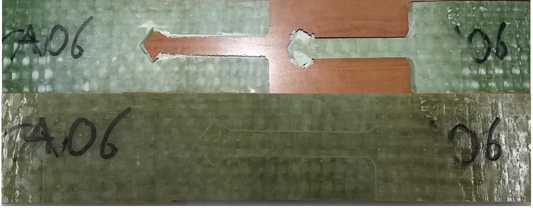
Şekil 4.22: Deneysel öncesi beşgen dil tasarımı (A06 numunesi) ve deneysel sonrası oluşan deformasyonlar
