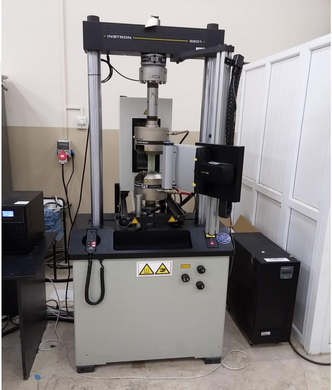
Şekil 3.5: INSTRON 8801 (100 kN) yorulma test cihazı
