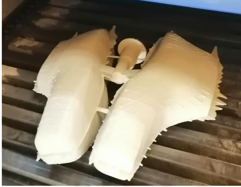
Resim 34: Polietilen Hammaddeden Üretilen Takoz Şeklindeki Kalıbın İlk Hali
