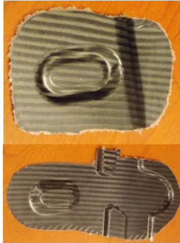
Resim 78: (a) ESRO parçaları, kesim öncesi üretimden sonra ve (b) ESRO Bölümü kesilmiş ve yapıştırılmış.
