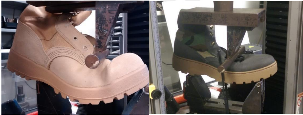
Resim 79. Taban çizgisi McCrae ACB-HW ve 3 noktalı bükümün altındaki prototip önlüğü
