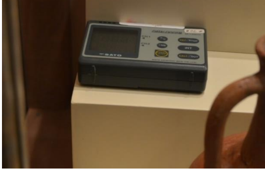
Resim 5. 41. Ortam koşullarını tespit ve izleme cihazları (Sıcaklık ve Bağıl Nem)
