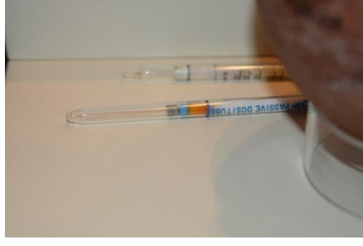
Resim 5.42. Ortam koşullarını anlık ölçüm cihazları (Asetik Asit ve Formaldehit)
