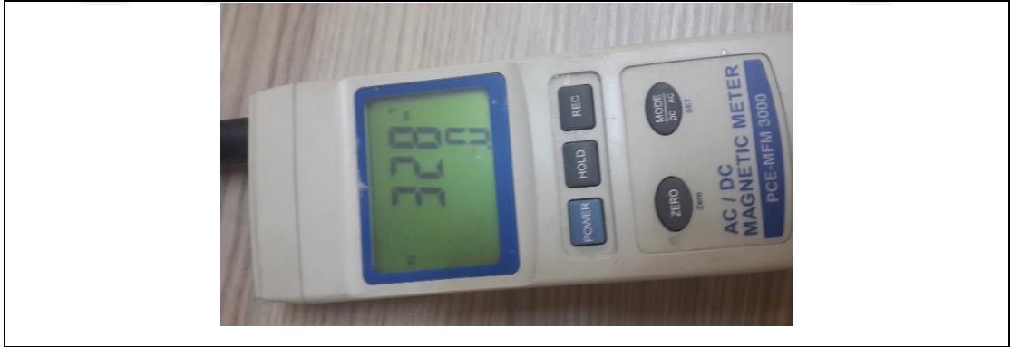
Şekil 2.3. Manyetik alan yoğunluğunun ölçümü (NdFeB mıknatıslar ile hücre kültür tabağında oluşturulan manyetik alan yoğunluğu manyetik akı ölçer ile ölçülmüştür; oluşturulan manyetik alanın B değerinin 328 mT olduğu görülmektedir)
