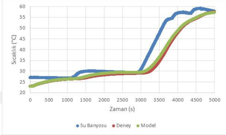
Şekil 4.6 Değişken sıcaklıkta su banyosunda yapılan deney ve model sonuç karşılaştırılması
