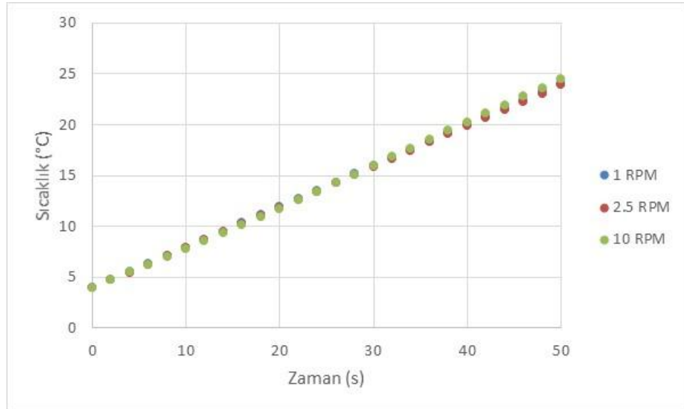
Şekil 4.47 750 W güç – 0.005 m/s akış hızına sahip matematiksel modellerde uygulanan farklı dönüş hızlarının mikrodalga sistemden çıkış noktasında üründen alınan ortalama sıcaklık değerleri
