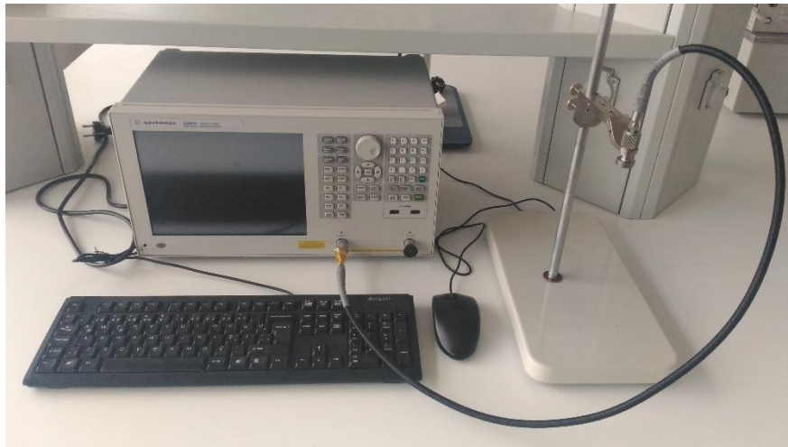
Şekil 3.9 Bira örneklerinin dielektrik özelliklerini ölçmek amacıyla kullanılan Network analiz sistemi
