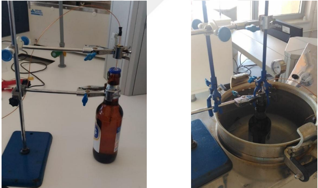
Şekil 3.5 Bira şişesi içerisinde su kullanılarak gerçekleştirilen deneylerde ürün sıcaklık ölçümünün yapılması amacıyla kurulan deney düzeneği
