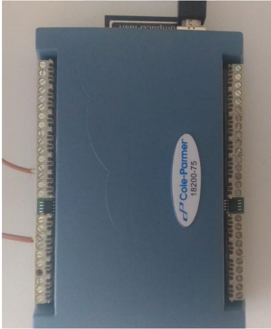
Şekil 3.3 (a) Sıcaklık veri toplama sistemi, Cole-Parmer 18200-75 ve (b) K-tipi ısı çiftleri
