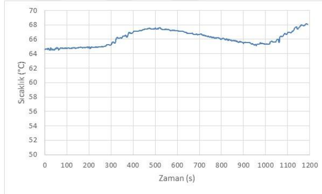
Şekil 3.23 Sabit sıcaklıkta su banyosunda yapılan deneyler esnasında, su banyosundan alınan ortam sıcaklık değerleri ve toplam proses süreleri
