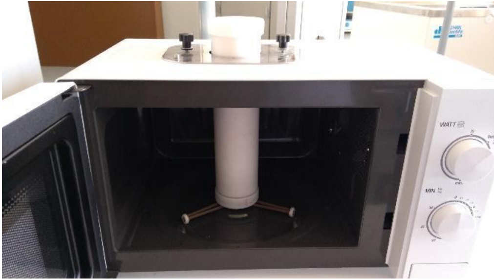
Şekil 3.6 Deneysel çalışmalarda kullanılan laboratuvar ölçekli LG MS2022D model mikrodalga fırın
