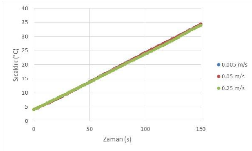
Şekil 4.52 350W güç - 10 rpm Arşimet vidası dönüş hızına sahip mikrodalga sistemde uygulanan farklı akış hızlarının, mikrodalga sistemde çıkış noktasında üründen alınan ortalama sıcaklık değerlerine olan etkisi
