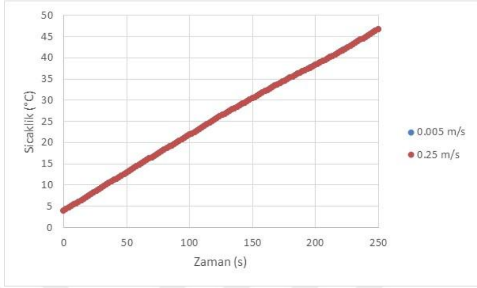
Şekil 4.54 350 W güç - 1 rpm Arşimet vidası dönüş hızında, uygulanan farklı akış hızlarının ürünlerin mikrodalga sistemden çıkış sıcaklıkları üzerine etkisi
