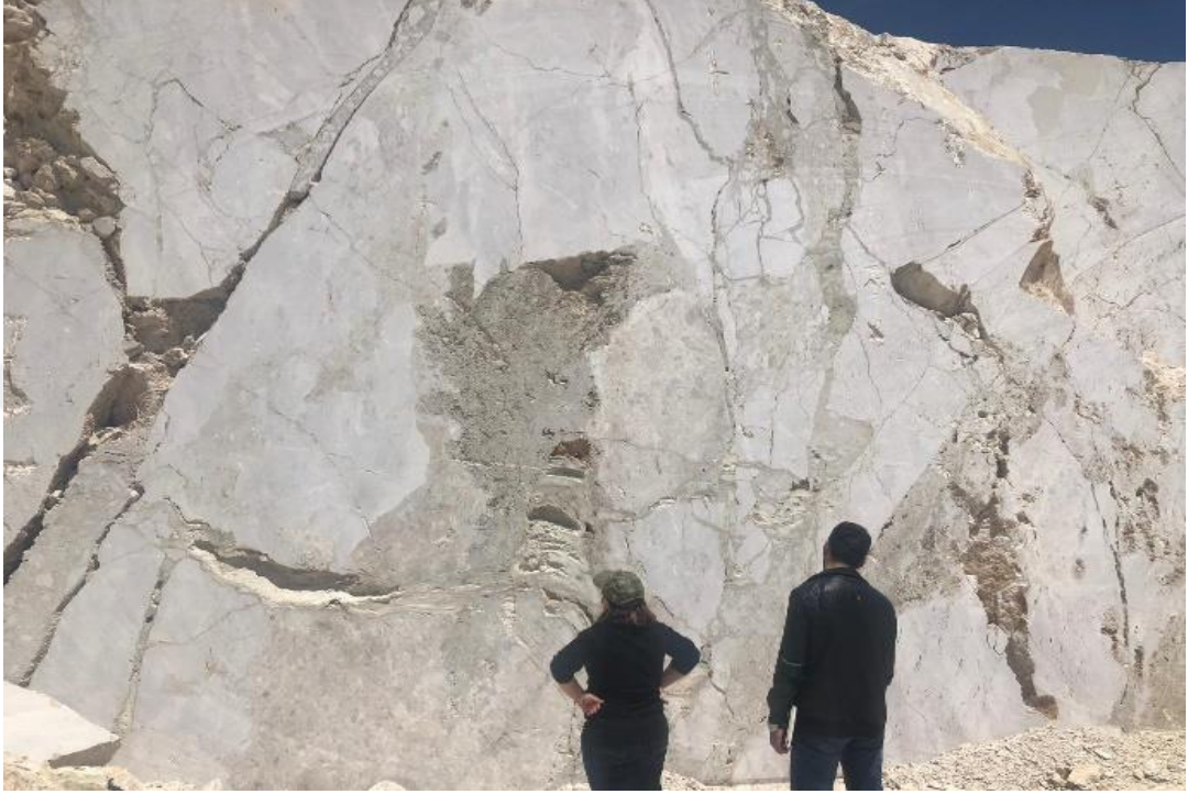
Şekil 4.17. Ayna üzerinde görülen bol kırık-çatlak, kil dolgu içerisinde rastlanan yer yer breşik malzeme (Kademe 5)
