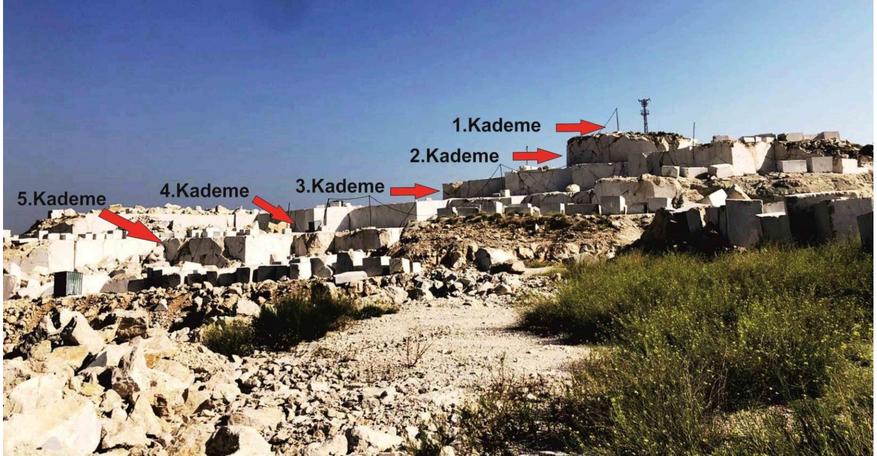
Şekil 4.8. Hacılar Ocağında kademelerin ve aynaların görünümü
