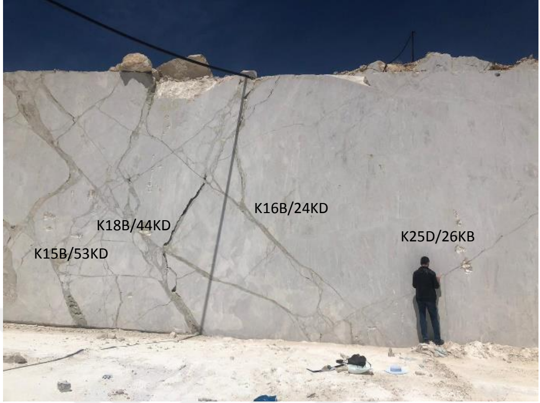
Şekil 4.14. Farklı yönlerde gelişen, yer yer breşik yapılı ve kil dolgulu çatlak (Kademe 3)
