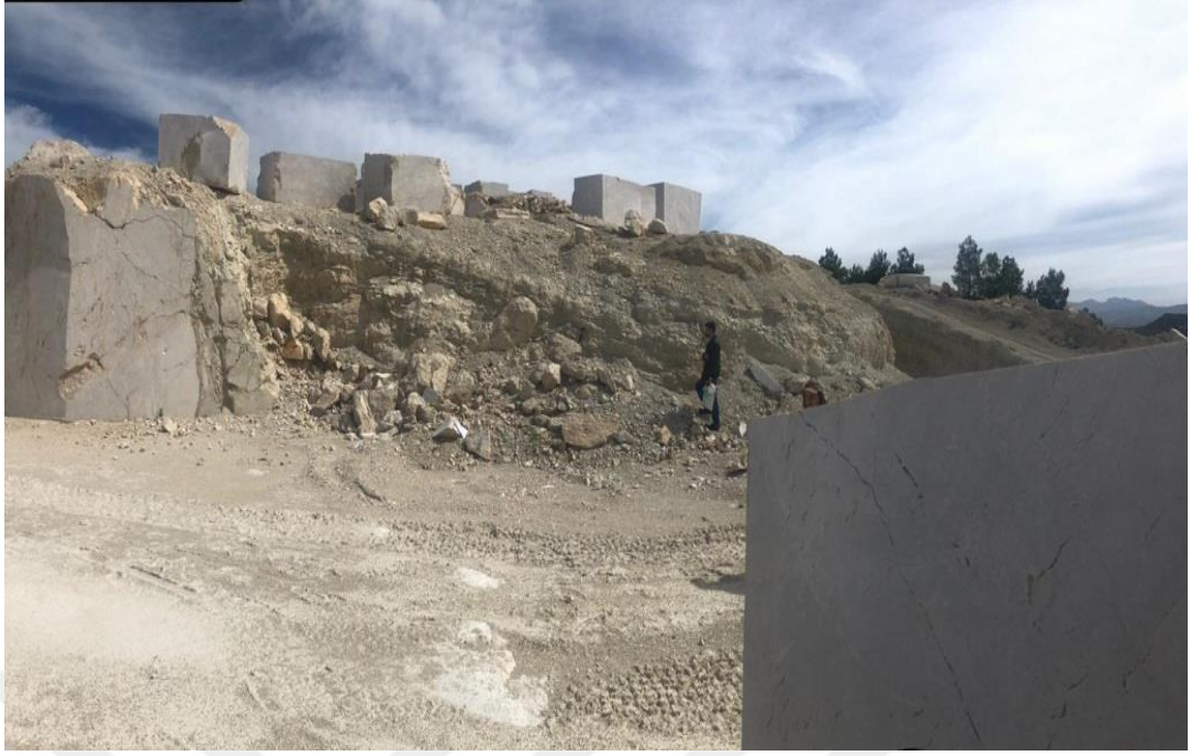
Şekil 4.18. Başmakçı formasyonu ile Hacılar kireçtaşlarının dokanak sınırı (Kademe 4 ün girişi)
