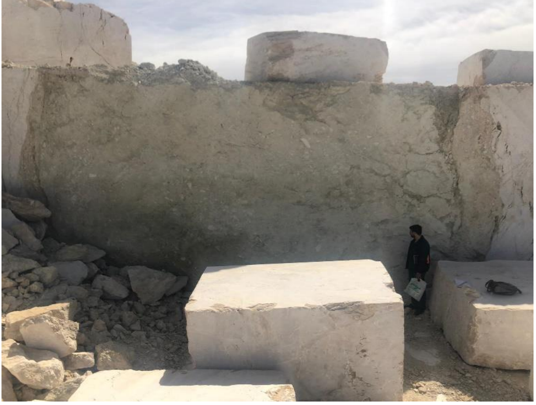
Şekil 4.20. Hacılar kireçtaşları arasına girmiş breşik malzeme içeren killi seviye (Kademe 4)
