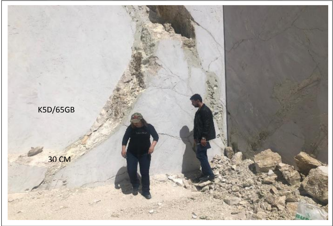
Şekil 4.10. Ayna üzerinde görülen erime boşlukları ve kil dolgusu (Kademe 4)
