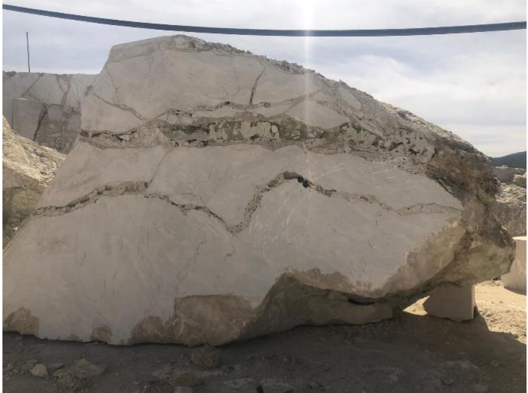
Şekil 4.19. Pasa üzerinde görülen erime boşlukları ve içerisindeki kil dolgusu ile silisli malzeme (Kademe 4)
