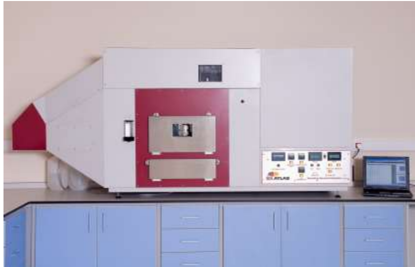
Şekil 2.7. Isıl Direnç Ölçüm Cihazı, SDL Atlas, M259B
