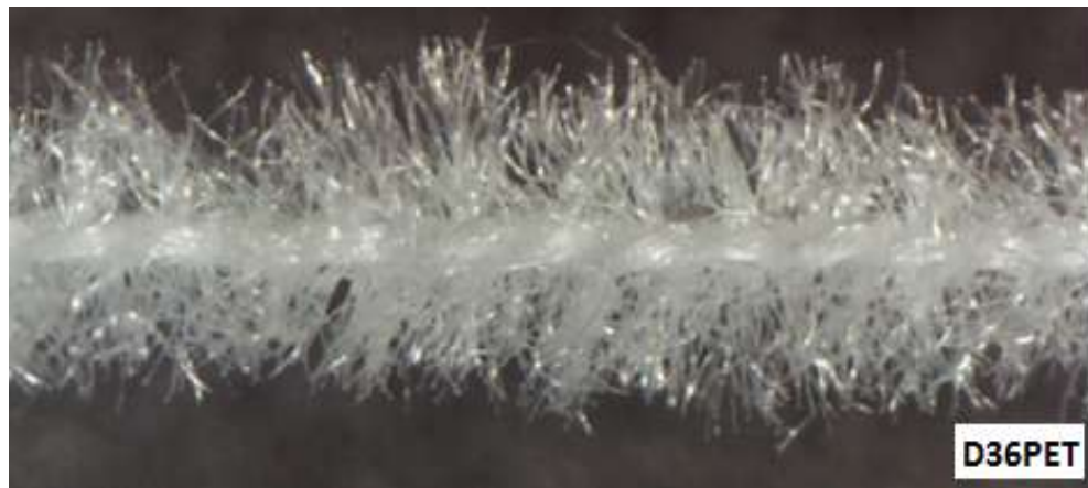
Kilit İpliği: Ne 40/1 Kompakt Pamuk + Ne 40/1 Kompakt Pamuk Hav İpliği: 100 den/36f PET Filament
