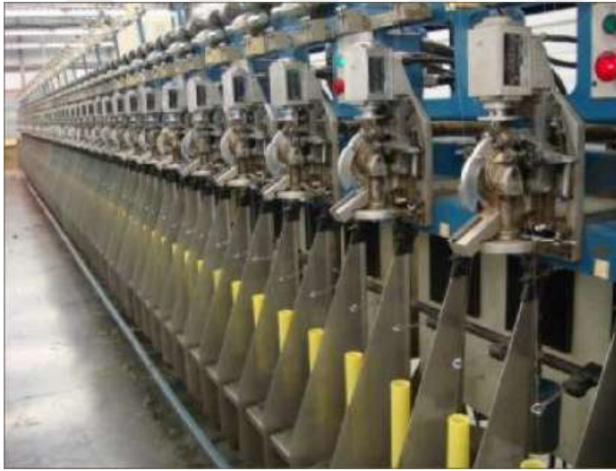
Şekil 1.2. Şenil İplik Üretim Makinesi ve İplik Oluşum Bölgesi [38].
