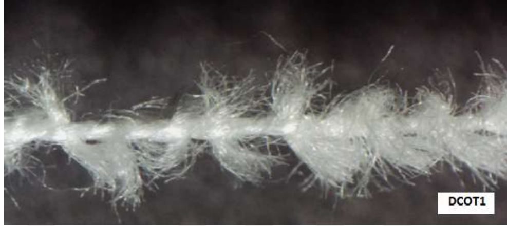
Kilit İpliği: Ne 40/1 Kompakt Pamuk + Ne 40/1 Kompakt Pamuk Hav İpliği: Ne 30/1 Kompakt pamuk, Kalibre 0.8 mm
