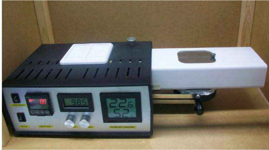
Şekil 2.8. Permetest su buharı geçirgenliği ölçüm cihazı.
