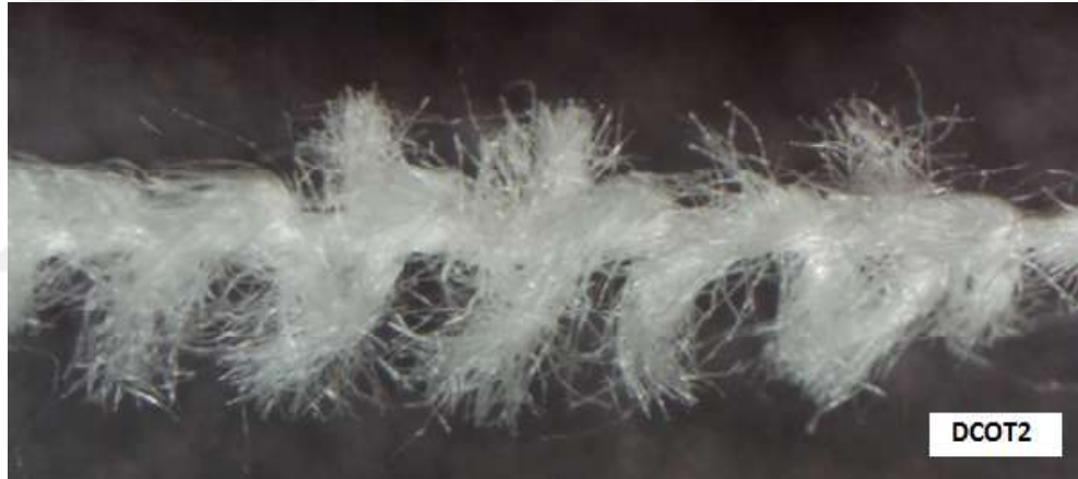
Kilit İpliği: Ne 40/1 Kompakt Pamuk + Ne 40/1 Kompakt Pamuk Hav İpliği: Ne 30/1 Kompakt pamuk, Kalibre 1 mm
