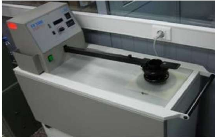
Şekil 2.6. Hava geçirgenliği test cihazı [54].
