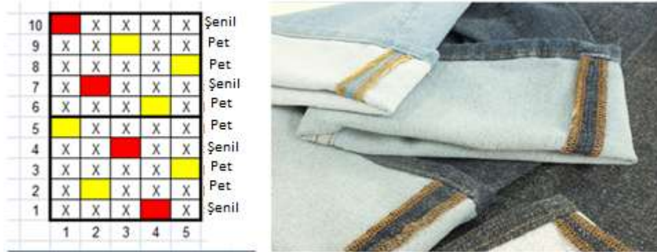
Şekil 2.3. Seçilen denim kumaş örgü yapısı ve görüntüsü.
