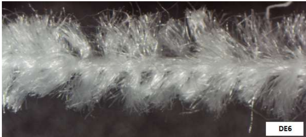
Kilit İpliği: Ne 40/1 ( % 50 Tencel / % 50 PET 22dtex Els.)+ Ne 40/1 ( % 50 Tencel / % 50 PET 22dtex Els.) Hav İpliği: Ne 30/1 50/50 Viloft/PET
