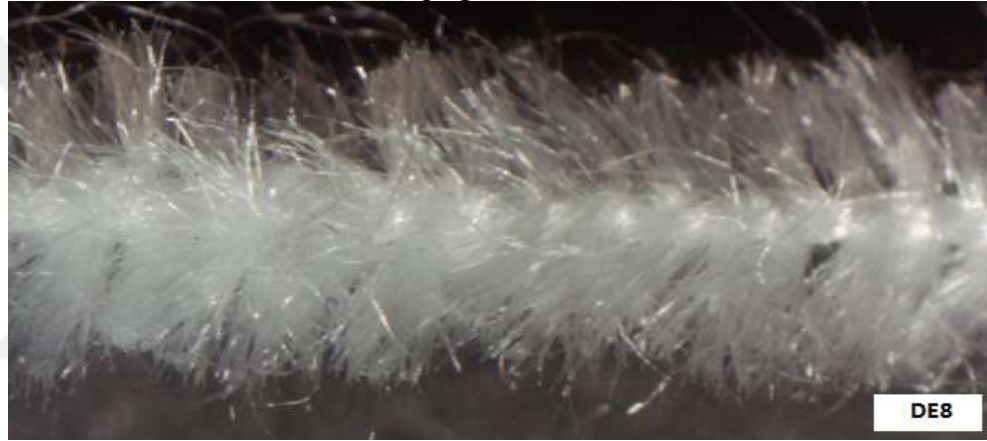
Kilit İpliği: Ne 40/1 ( % 50-50 Tencel- PET 44dtex Els.) + Ne 40/1 ( % 50-50 Tencel- PET 44dtex Els.) Hav İpliği: Ne 30/1 50/50 Viloft / PET
