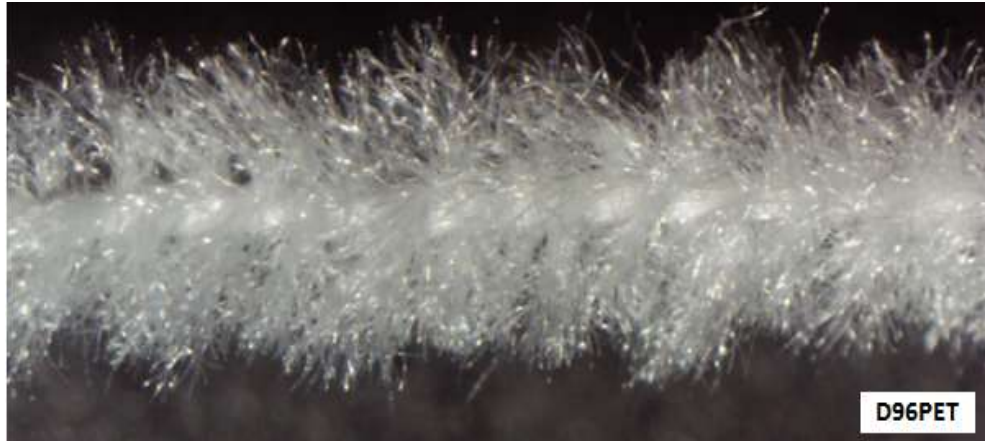
Kilit İpliği: Ne 40/1 Kompakt Pamuk + Ne 40/1 Kompakt Pamuk Hav İpliği: 100 den/96f PET Filament
