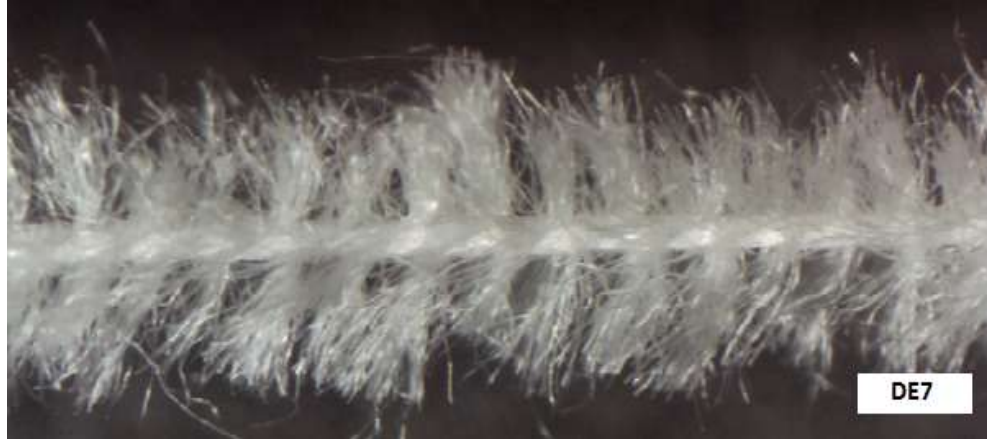
Kilit İpliği: Ne 40/1 ( % 50 Tencel / % 50 PET 22dtex Els.)+ Ne 40/1 ( % 50 Tencel / % 50 PET 22dtex Els.) Hav İpliği:40/1 Akrilik
