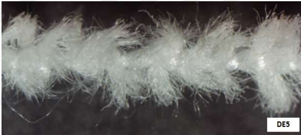
Kilit İpliği: Ne 40/1 ( % 50 Tencel / % 50 PET 22dtex Els.)+ Ne 40/1 ( % 50 Tencel / % 50 PET 22dtex Els.) Hav İpliği: Ne 30/1 Kompakt Pamuk
