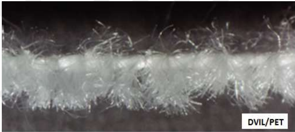
Kilit İpliği: Ne 40/1 Kompakt Pamuk + Ne 40/1 Kompakt Pamuk Hav İpliği: Ne 30 Viloft-PET 50-50
