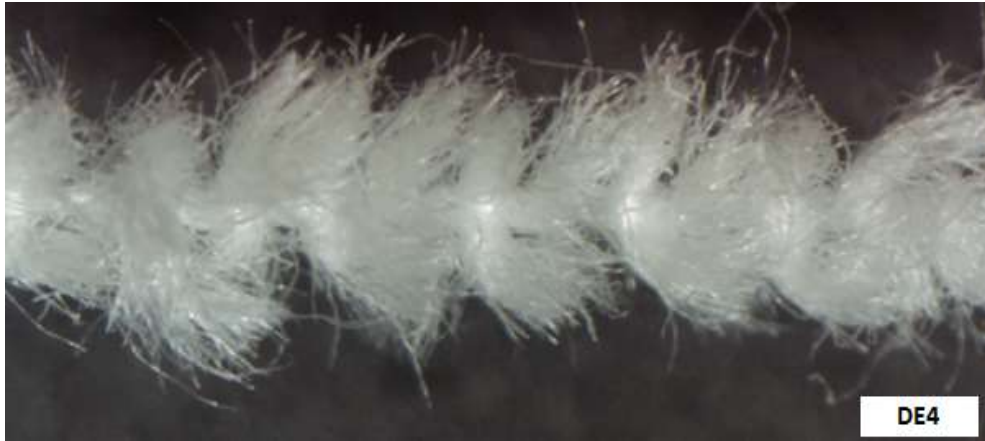
Kilit İpliği: Ne 30/1 ( % 50 Tencel / % 50 PET 44dtex Els.) + Ne 30/1 Kompakt Pamuk – Hav İpliği: Ne 30/1 Kompakt Pamuk
