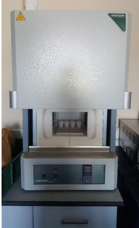
Şekil 3.13 Ham kül analizi için örnek yakma fırını
