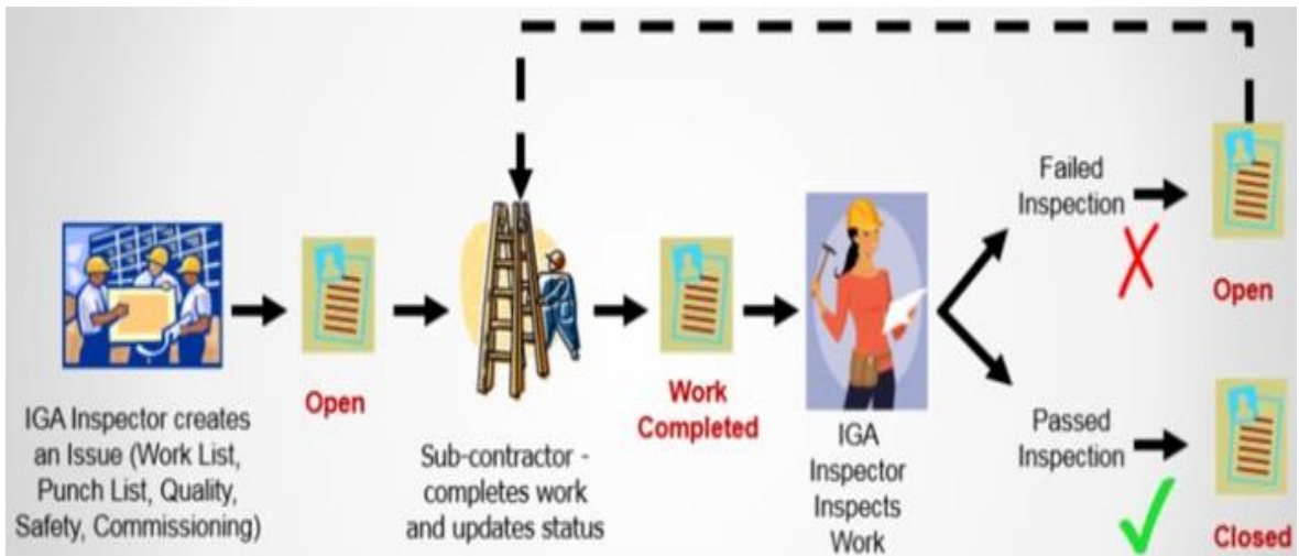
Şekil 4.2: Mekanik sistemlerin yapımı için belirlenen iş yapım metodu
