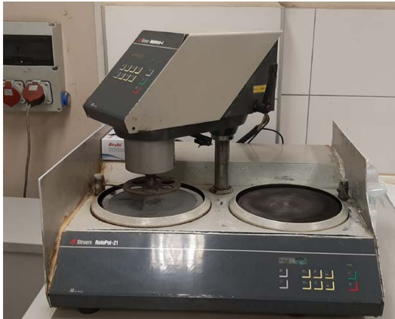
Şekil 3.16. Struers marka RotoPol-21 modeli otomatik parlatma cihazı.
