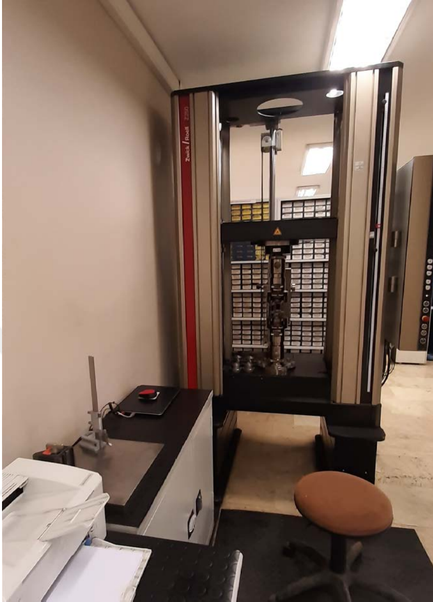
Şekil 3.19. Zwick Roell Z250 Çekme Test Cihazı.
