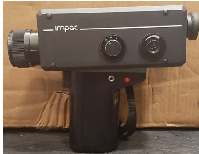
Şekil 3.10. Impac marka pirometre
