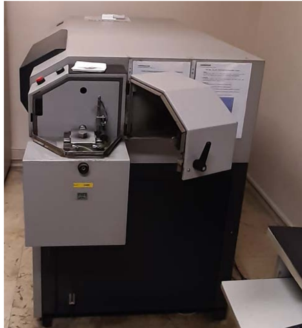
Şekil 3.3. Thermo Scientific ARL 4460 markalı spektrometre.
