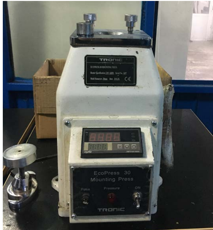
Şekil 3.14. Tronic marka bakalit kalıplama cihazı.
