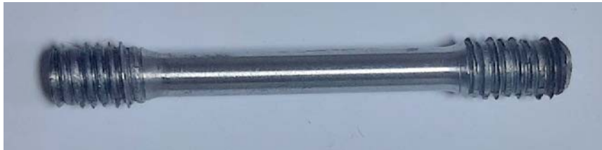
Şekil 3.20. İşlenmiş çekme parçası.
