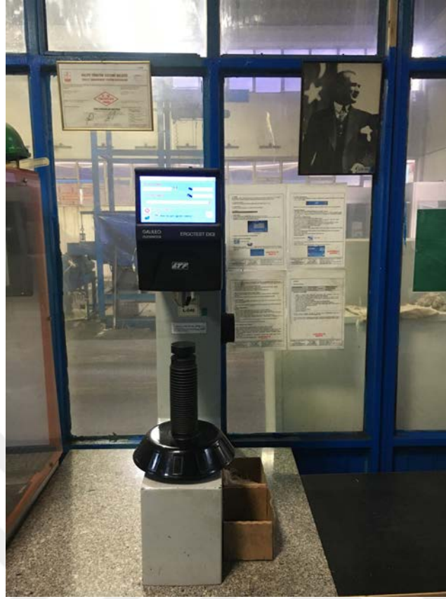
Şekil 3.22. Galileo Ergotest dijital sertlik ölçüm cihazı.
