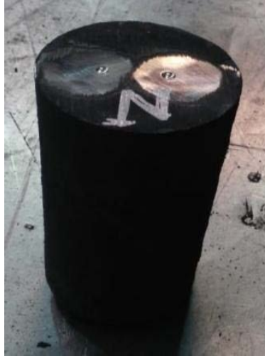
Şekil 3.15. Mikroyapı incelemesi için bakalit kalıba alınmış numune.
