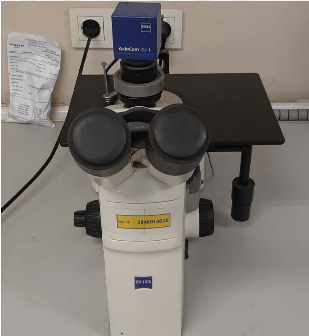
Şekil 3.17. Zeiss Axio inverted mikroskop.
