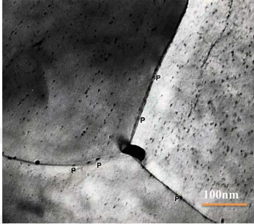
Şekil 2.8. Vanadyum karbürün tane sınırlarına etkisi [13].
