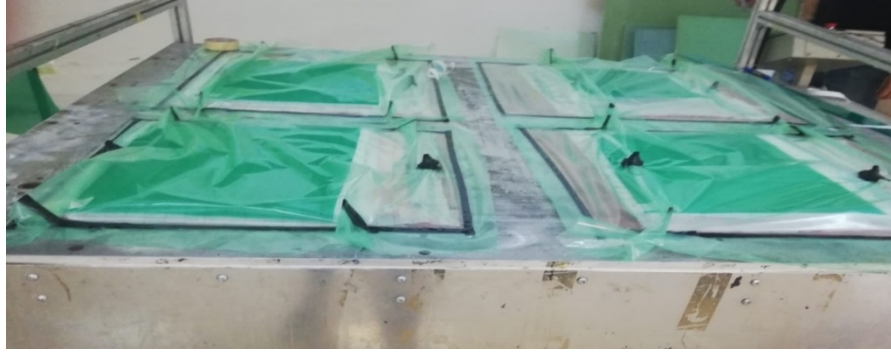
Şekil 2.8 Tabakalı takviye kumaşların vakum torbasına alınması (Kişisel arşiv, 2019)
