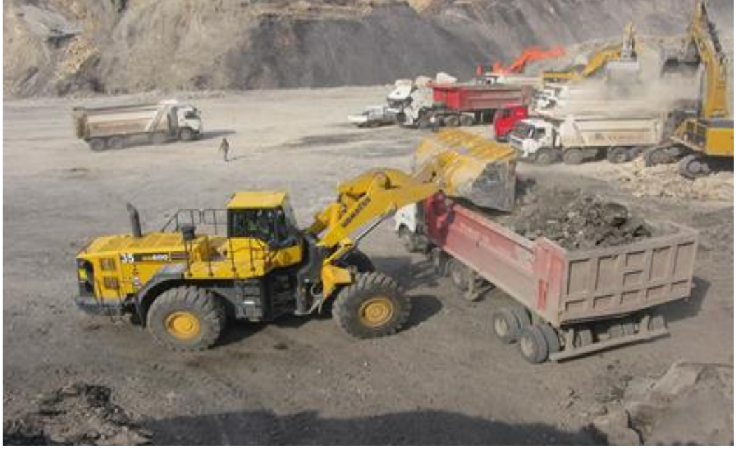
Şekil 4.28. Olivin Ocağında iş makinalarının yükleme işlemleri
