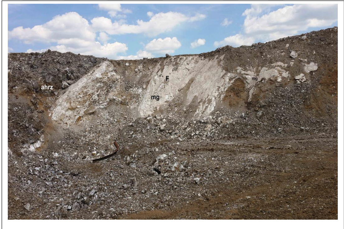
Şekil 4.17. Ocakta gözlenen fayın kayma yüzeyi (f) ve manyezit (mg) oluşumunun yakın görünümü (Dakduklu-4 nolu olivin ocağı)
