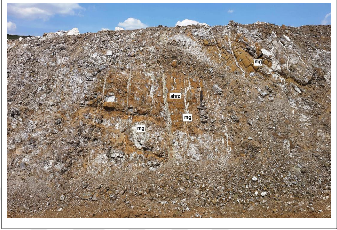
Şekil 4.18. Ocak içerisinde yoğun ayrılmış harzburjitik peridotitlerdeki (ahrzprd) kırıklara yerleşen bireysel ve ağsal manyezit (mg) damarları (Dakduklu-4 nolu olivin ocağı)
